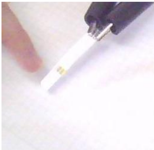
Figura 2.6 – Biossensor onde ocorre a reação química.
