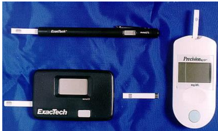
Figura 2.4 - Biossensores amperométricos comerciais utilizados em análises clínicas 4 .
