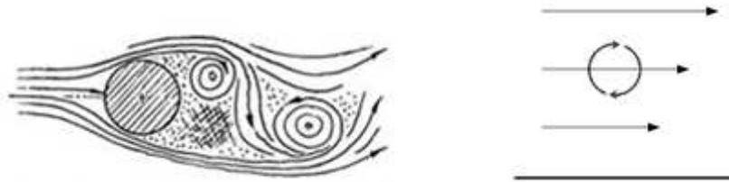
Figura 4.3 – Separação do escoamento com detalhes interior da camada limite. (Fontes: [http//www](http://www)).
