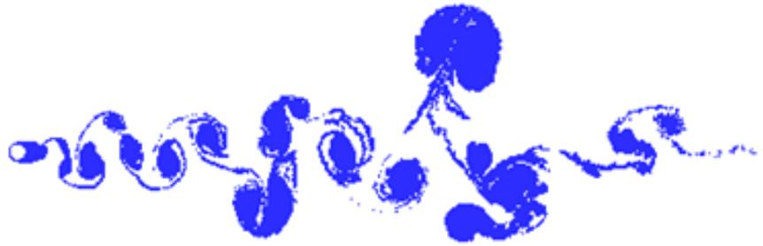
Figura 5.30 – Estrutura da esteira de vórtices para o tempo final  $t=50$  do caso do cilindro circular oscilando in-line ( $M=300$ ,  $N=300.000$ ,  $\Delta t=0,05$ ,  $\sigma_0=\text{eps}=0,001$ ,  $\text{Re}=10^5$ ,  $A=0,13$ ,  $\alpha=0^\circ$  e  $f_o / f_s =0,4$ ).
