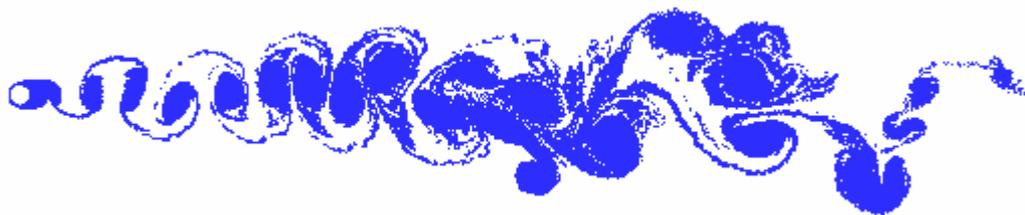
Figura 5.10 – Estrutura da esteira de vórtices para o tempo final  $t=50$  do caso do cilindro circular estacionário ( $M=300$ ,  $N=300.000$ ,  $\Delta t=0,05$ ,  $\sigma_0=\epsilon=0,001$ ,  $Re=10^5$ ).
