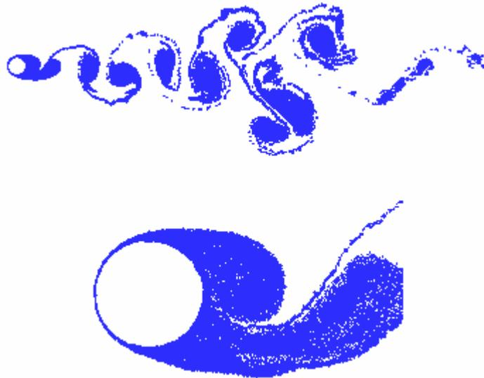
Figura 5.5 – Detalhes do desprendimento de uma estrutura vorticosa horária correspondente ao instante de tempo  $t=28,85$  (Ponto A).
