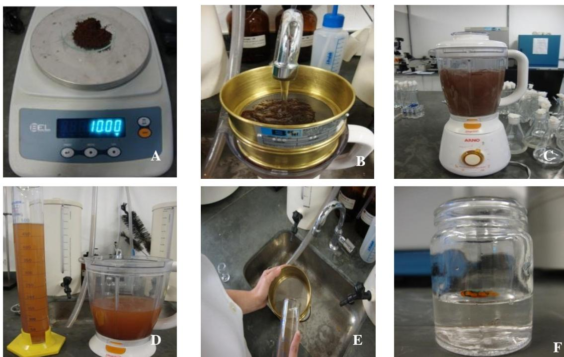
**Figura 13** - Extração de micélio extrarradicular A- pesagem da amostra de solo, B - peneiramento do solo e transferência para 1500 mL de água de torneira, C - agitação mínima durante 30 s no liquidificador, D - alíquota de 500 mL, E - peneiramento em malha de 0,045 mm e F - transferência para frasco de 11 mL.
