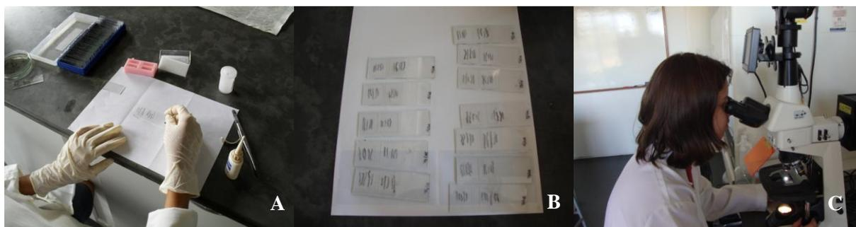
**Figura 11** - Análise de intensidade de colonização radicular: A – Montagem da lâmina; B - Lâmina de microscopia com 10 segmentos de raízes; C – Observação dos segmentos de raízes em microscópio óptico.
