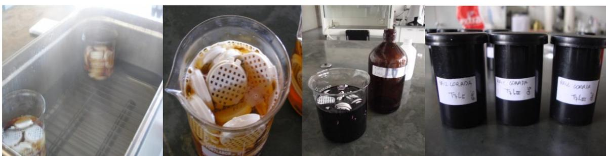
**Figura 10** - Procedimento de clarificação e coloração das raízes: A – cozimento em banho-maria a 90°C em KOH 10%; B – clarificação com H<sub>2</sub>O<sub>2</sub> a 3%; C – coloração com solução de ácido acético 5% e tinta de caneta tipo tinteiro; D- Raízes coradas armazenadas em recipientes plásticos identificados.
