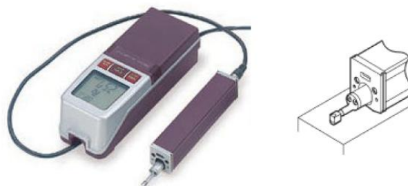
Figura 3.7 – Rugosímetro portátil utilizado no experimento.
