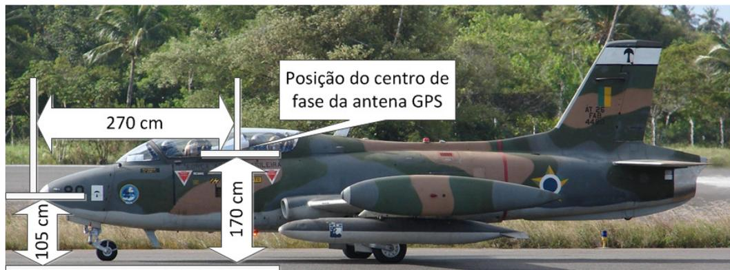
FIGURA 4.40 – Posição do centro de fase da antena GPS na aeronave.
