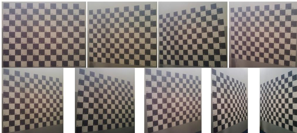
FIGURA 4.5 – Conjunto de imagens usadas na calibração da câmera LSC CCD.
