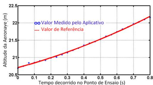
FIGURA 4.53 - Altitude de referência e calculada pelo ALG#1 para a aeronave H-55.
