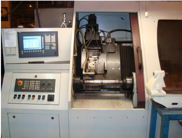
Figura 5.1 – Máquina ferramenta: a) vista geral externa, b) início do torneamento de uma árvore. Fonte: Mahle (2008).
