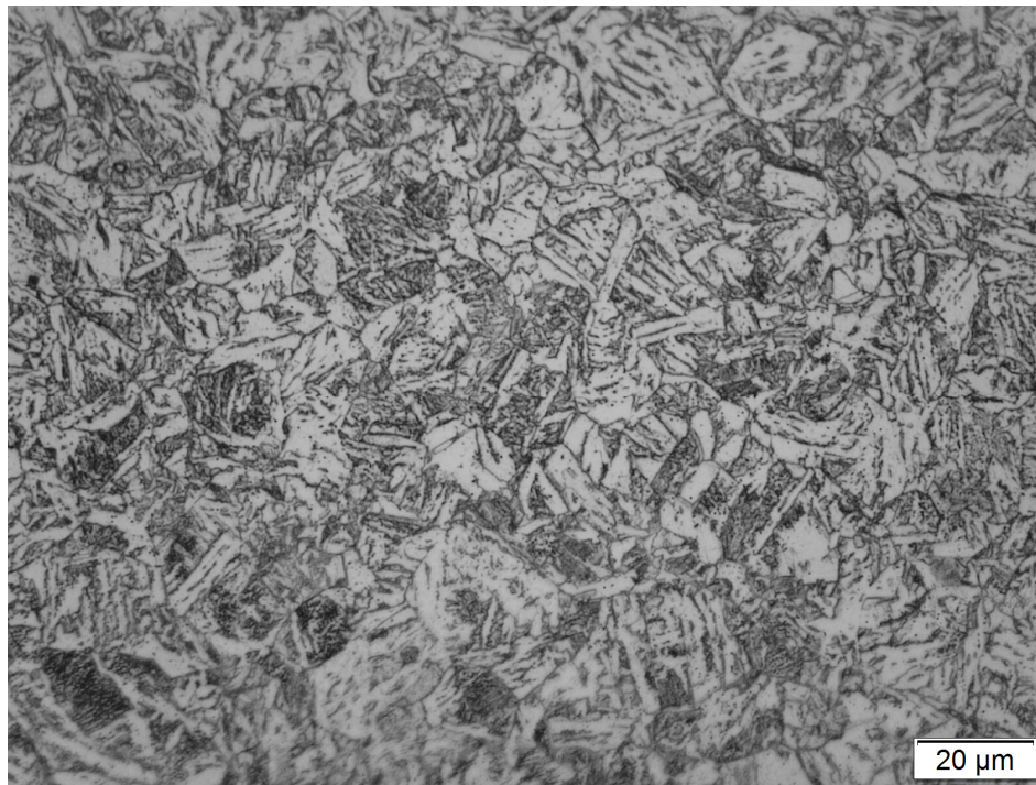
Figura 2.11 – Estrutura Martensítica Revenida em aço baixo carbono e baixa liga, atacada com nital.
