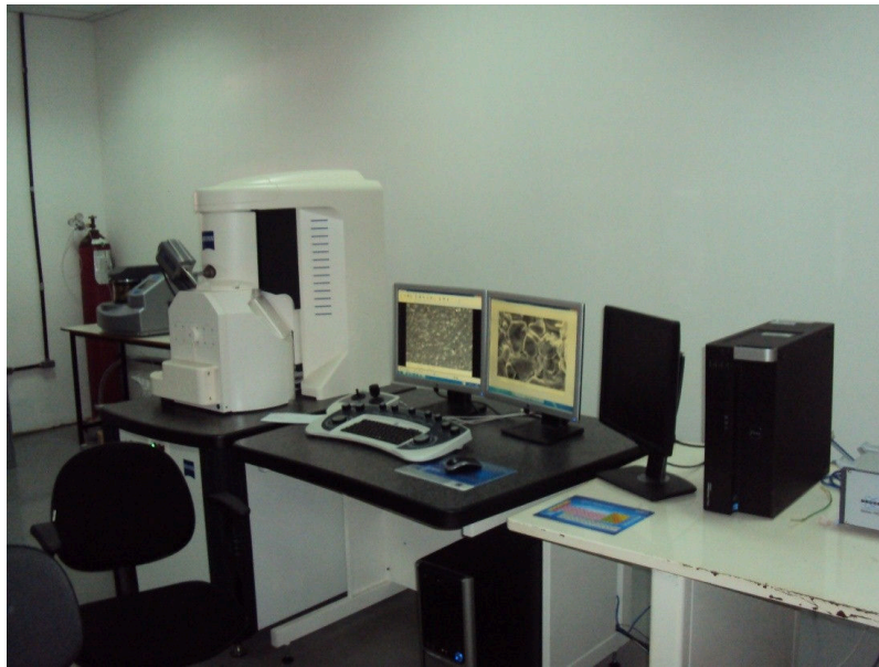
Figura 3.27 – Microscópio Eletrônico de Varredura (MEV) e Espectroscopia de energia dispersiva (EDS)
