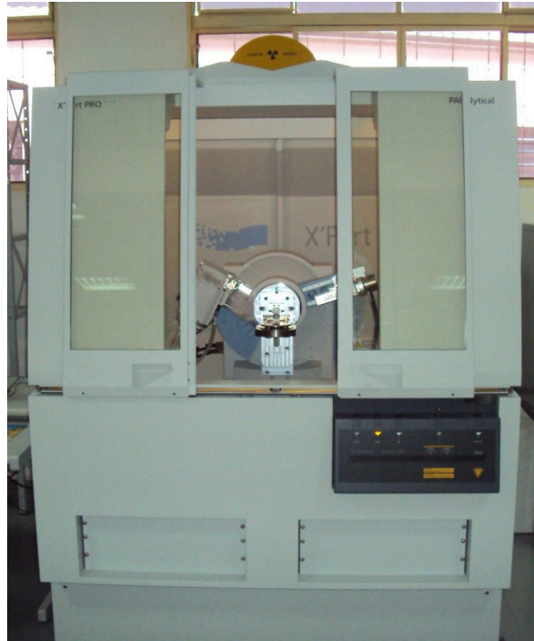
Figura 3.29 – Difratômetro de raios x X'Expert PRO da Pan analytical
