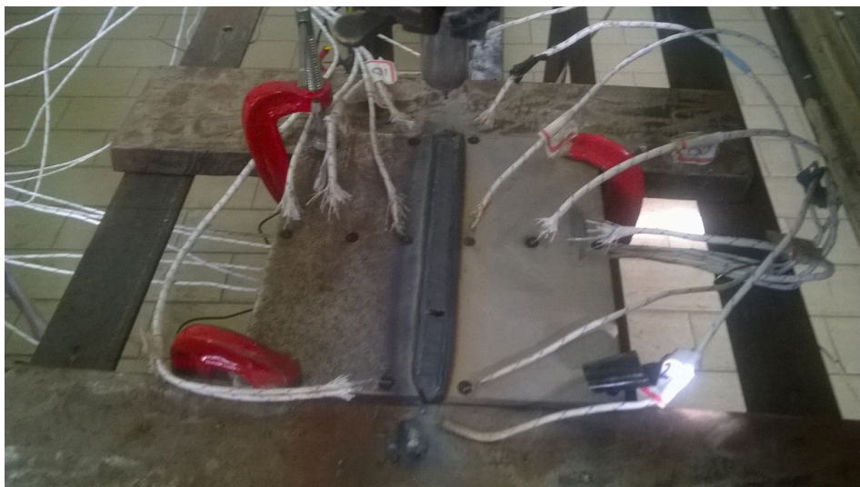
Figura 3.23 – Corpo de prova após a execução da soldagem
