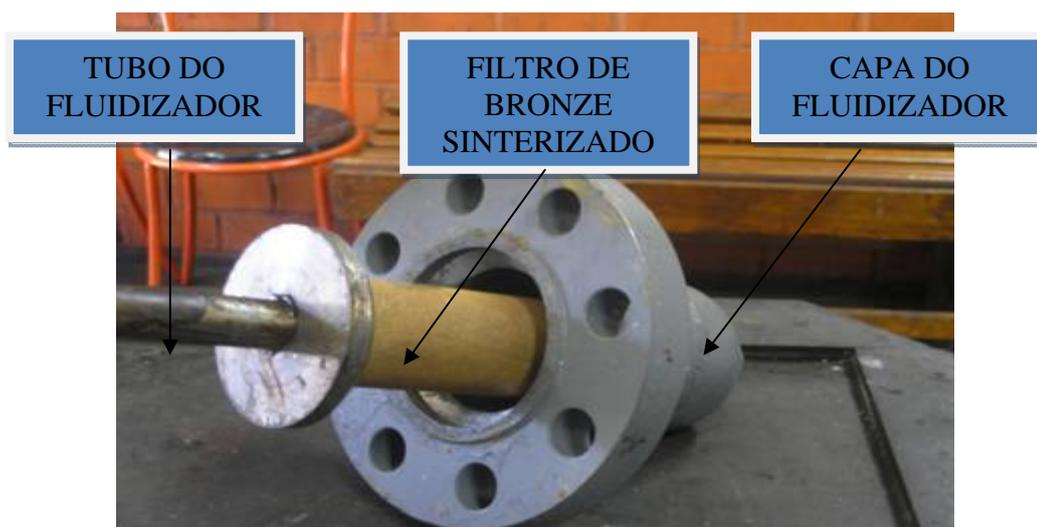
Figura 4.9 - Conjunto montado do fluidizador do vaso
