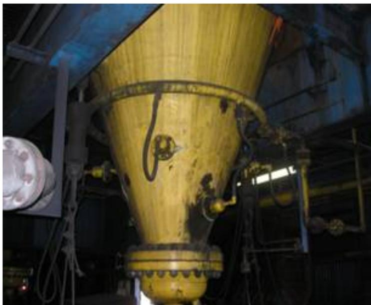
Figura 2.27 - Anel de fluidização do vaso de injeção de carvão pulverizado
