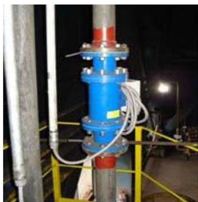
Figura 7.1 - Tubo sensor instalado na linha de injeção
