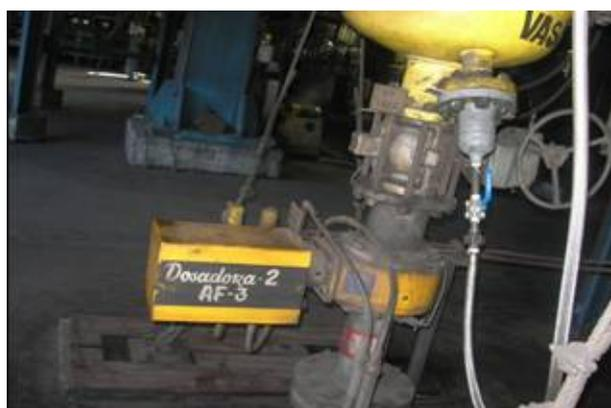
Figura 2.24 - Válvula dosadora de carvão pulverizado do vaso do AF3
