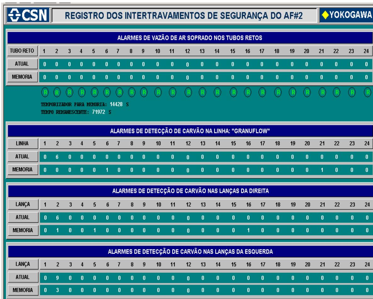
Figura 5.5 - Programa de contagem dos alarmes de intertravamentos das válvulas de carvão
