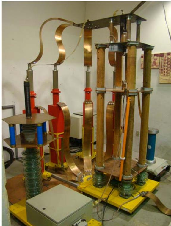
Fig. 5.7 – Gerador de impulsos de corrente de curta duração<sup>[3]</sup>
