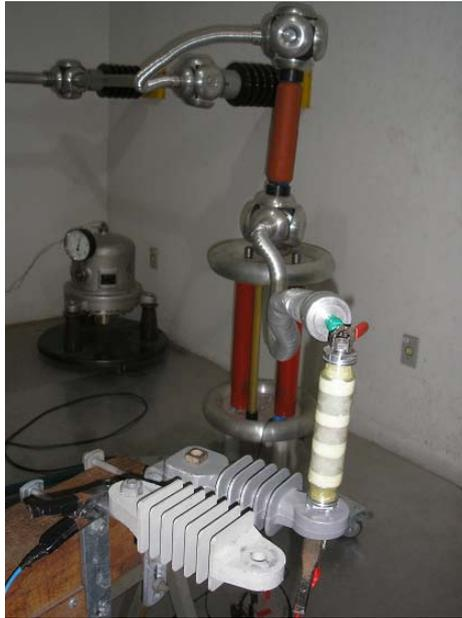
Fig. 5.5 – Arranjo para medição de tensão de rádio interferência
