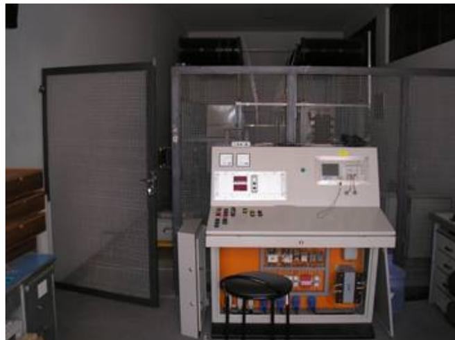
Fig. 5.10 – Gerador de impulso de corrente de longa duração – Painel de controle
