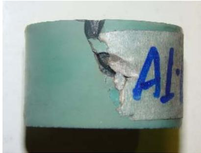
Fig. 2.8 – Falha de um varistor após a aplicação de impulsos de corrente de 40 kA.
