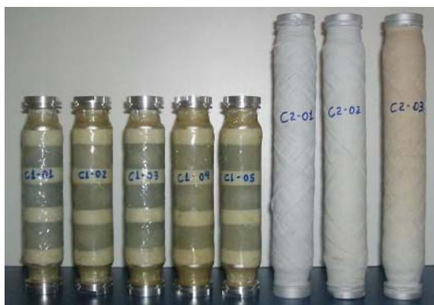
Fig. 2.10 – Fotografias de módulos de para-raios utilizados no projeto, 15 kV e 24kV.
