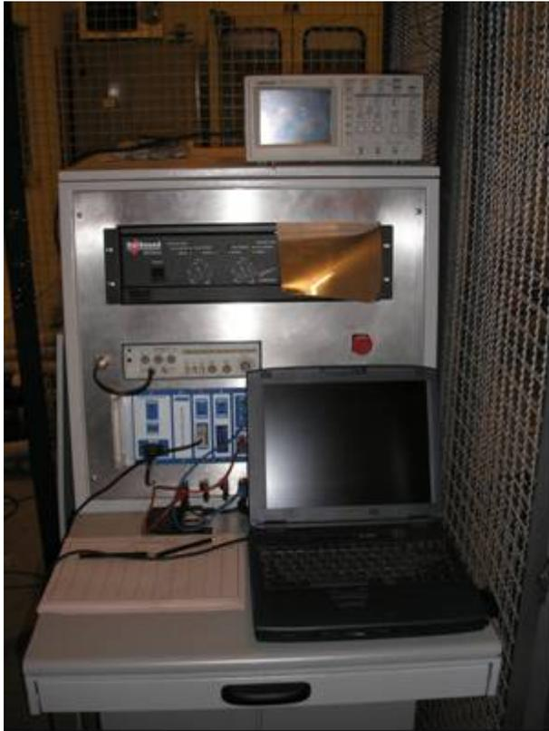
Fig. 5.1 - Fonte de tensão senoidal de 60 Hz e Painel de controle e sistema de aquisição
