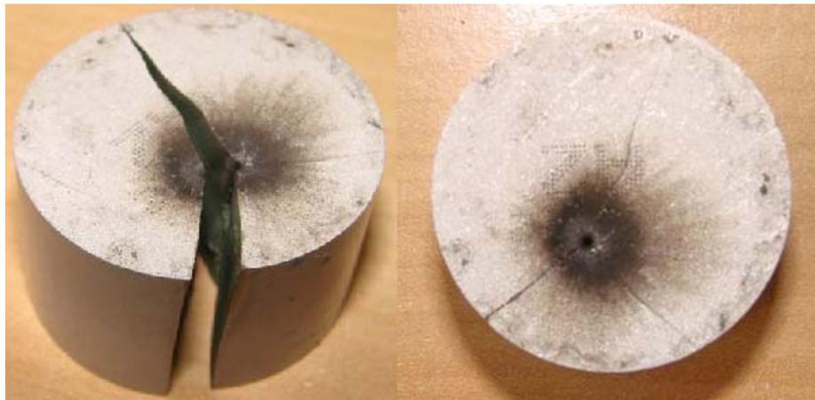
Fig. 5.12 – Falha apresentada no varistor A1 após a aplicação do impulso de corrente de longa duração.
