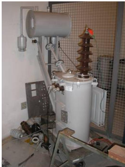
Fig. 5.3 - Transformador de alta tensão alimentado pela fonte de 60 Hz
