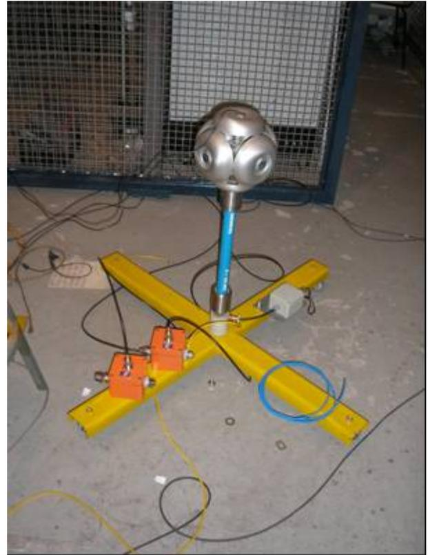
Fig. 5.2 - Divisor resistivo e shunt para medição de tensão e corrente
