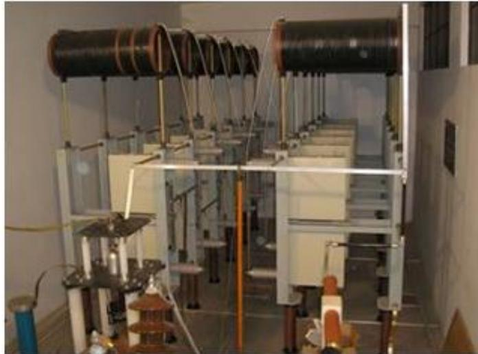
Fig. 5.9 – Gerador de impulso de corrente de longa duração
