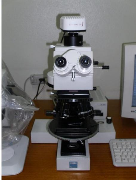
Figura 21 – Microscópio utilizado para observar a microestrutura dos corpos de prova.
