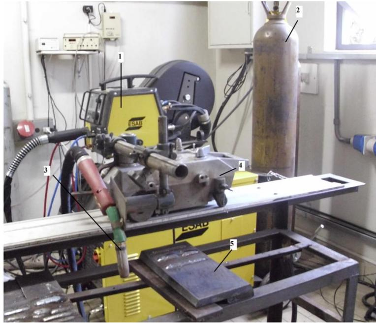
Figura 14 – Banco de ensaios. 1- fonte de soldagem. 2- gás de proteção. 3- tocha. 4- carro tartaruga. 5- corpo de prova.
