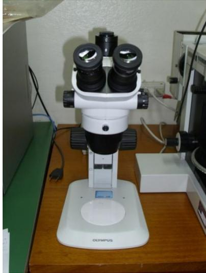
Figura 16 – Estereomicroscópio utilizado para ampliação dos cordões de solda.
