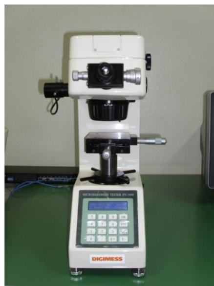
Figura 18 – Microdurômetro utilizado para ensaios de microdureza Vickers.
