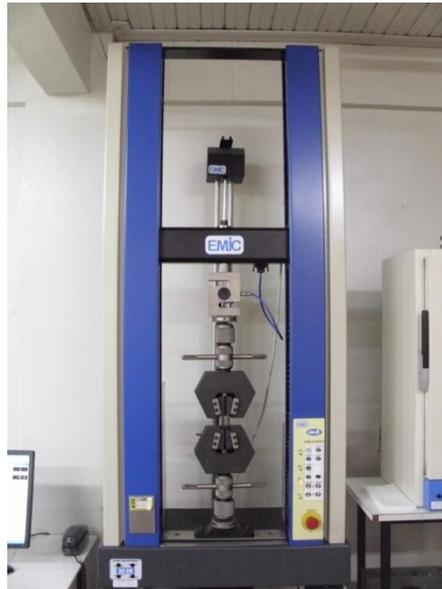
Figura 20- Equipamento utilizado para os ensaios de tração.
