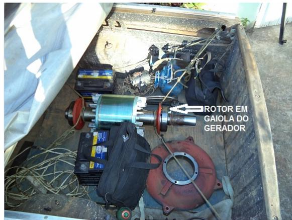
Figura 6.15: Rotor(*squirrel cage*) do gerador de indução em manutenção
