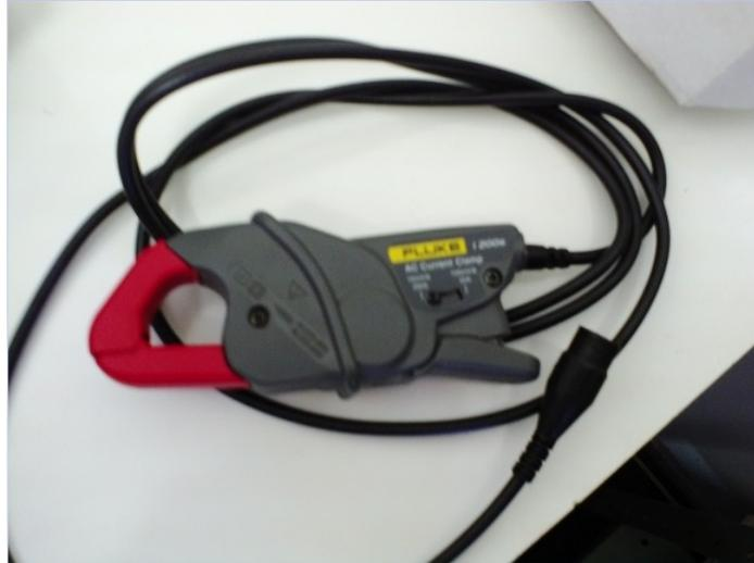
Figura 6.1: *Clamp* de corrente utilizado em conjunto com osciloscópio para oscilografia das formas de onda
