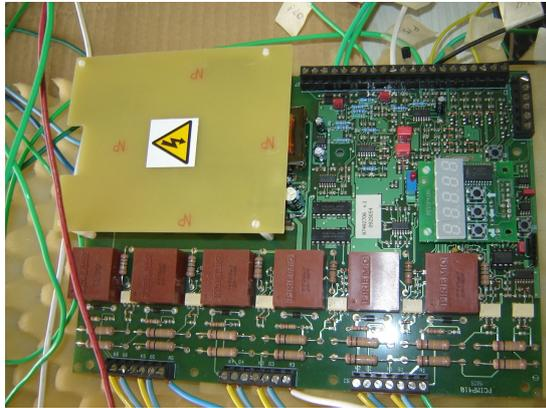
Figura 4.8: Placa eletrônica SEMIKRON MP410T
