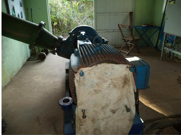
Figura 6.14: Carcaça do gerador de indução em manutenção
