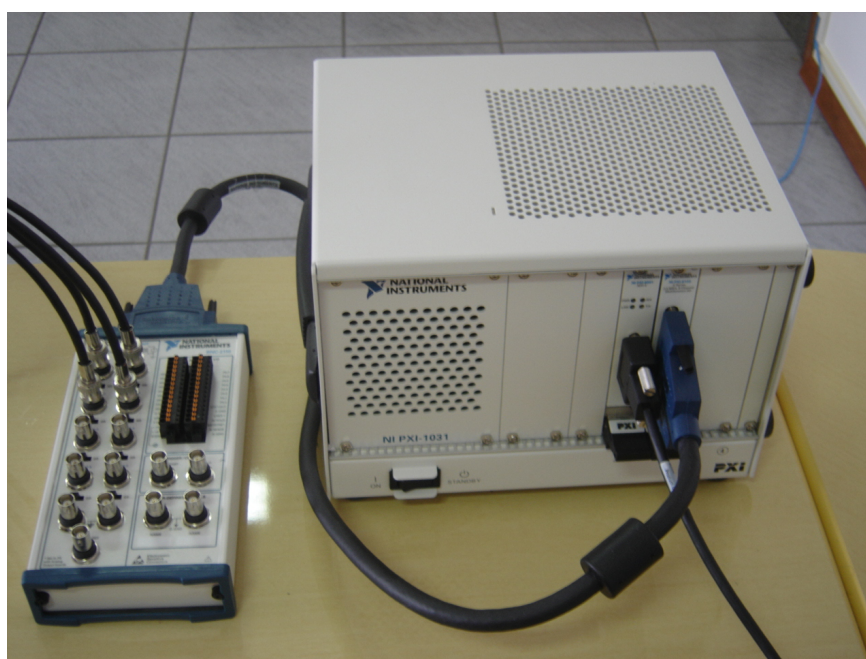
Figura 6.2: Sistema de aquisição de sinais NI PXI-6133.
