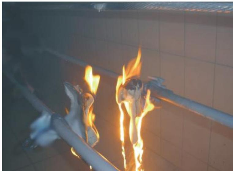
Figura 4.12 - Fotografia de espaçador incendiado.
