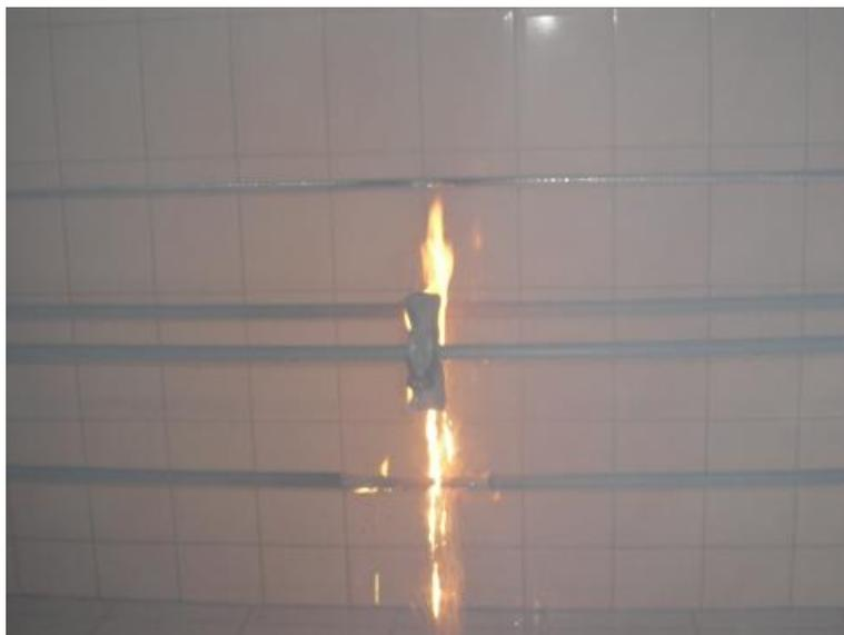
**Figura 4.13 - Fotografia de espaçador incendiado.**
