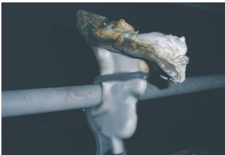
**Figura 4.14 - Fotografia do berço de um espaçador queimado.**
