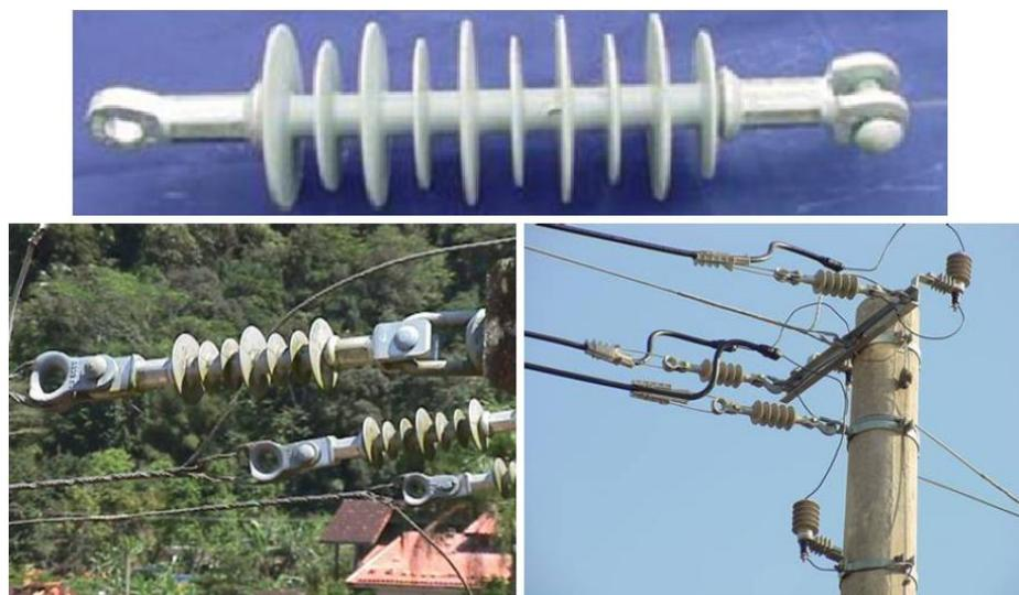
Figura AI.12 - Fotografias de isolador de ancoragem polimérico utilizado nas redes compactas.
