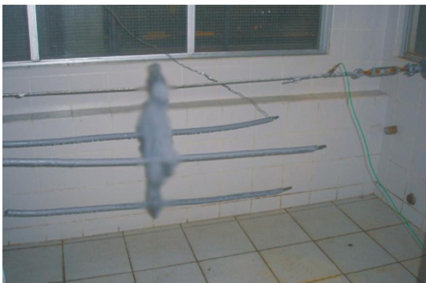
**Figura 5.1 -Fotografia que ilustra como foi realizada a medição das correntes de fuga.**
