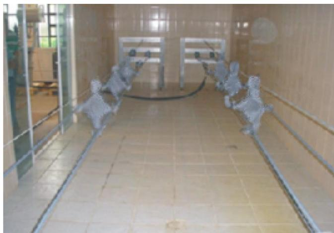
Figura 3.3 - Fotografia de ensaio de compatibilidade dielétrica em dois conjuntos.
