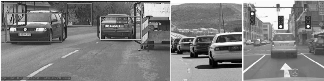
Figura 2 - (a) detecção de obstáculos {fonte [(KATO et al., 2002)]}, (b) acompanhamento de carro em comboio {fonte [(BISHOP, 2005)]}, e (c) acompanhando veículos, com identificação de semáforos, situação de parar e seguir e evitar colisão {fonte [(BISHOP, 2005)]}.
