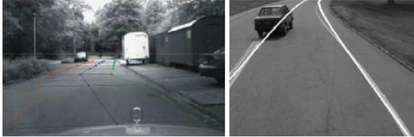
Figura 1 - (a) Planejamento de rota local utilizando Redes Bayesianas [fonte (YAGI et al., 1995)], (b) identificação da pista por visão computacional [fonte (THORPE et al., 1988)].
