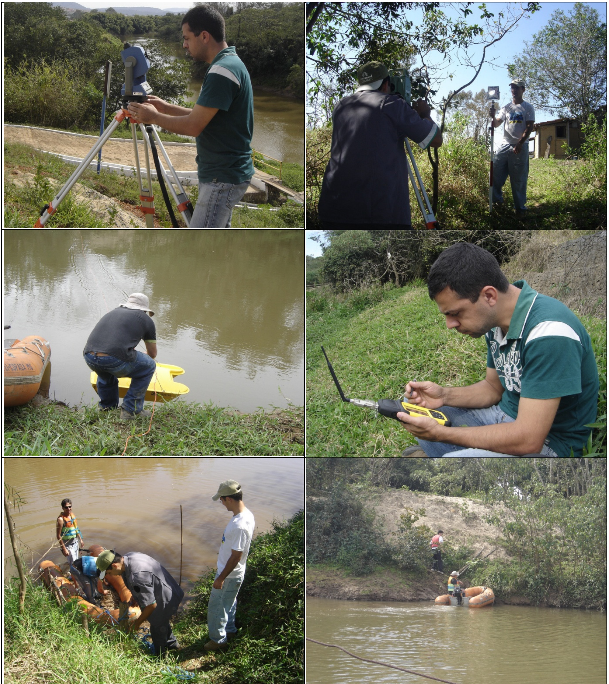
Figura A3: Mosaico de fotos do trabalho de campo em Pouso Alegre, medições de topobatimetria e vazão das seções de controle, em 2009.
