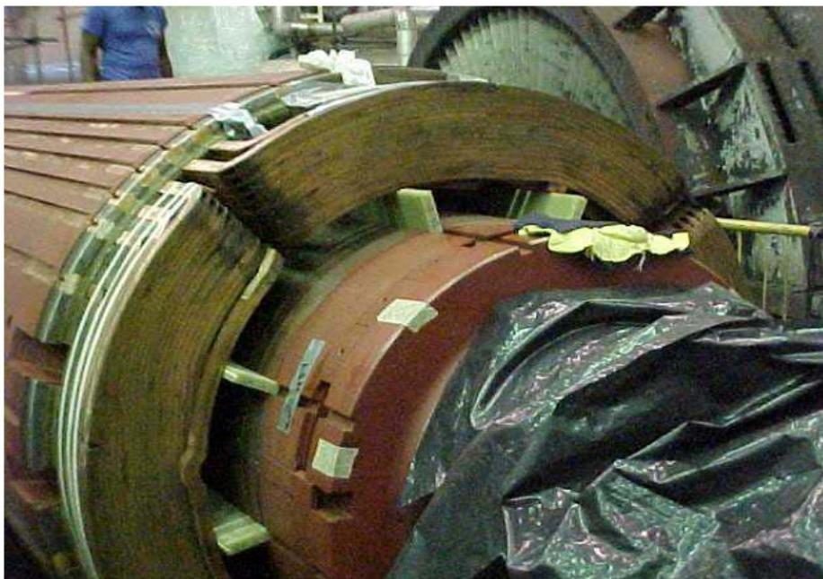
**Fig. II.2 - Rotor de um gerador síncrono de pólos lisos [10].**
