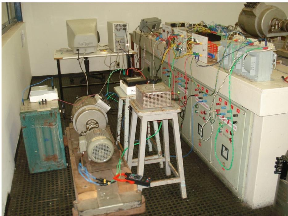
**Fig. IV.9 - Montagem do SVC Binário em laboratório.**
