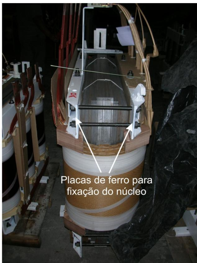
**Figura 3.15 – Placas de ferro sendo montadas.**
