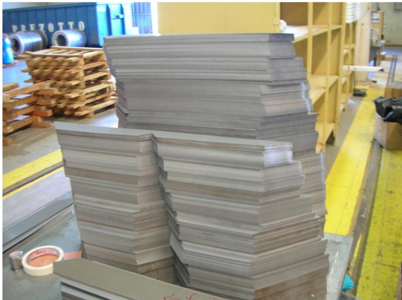
**Figura 5.3 – Lâminas de aço-silício.**
