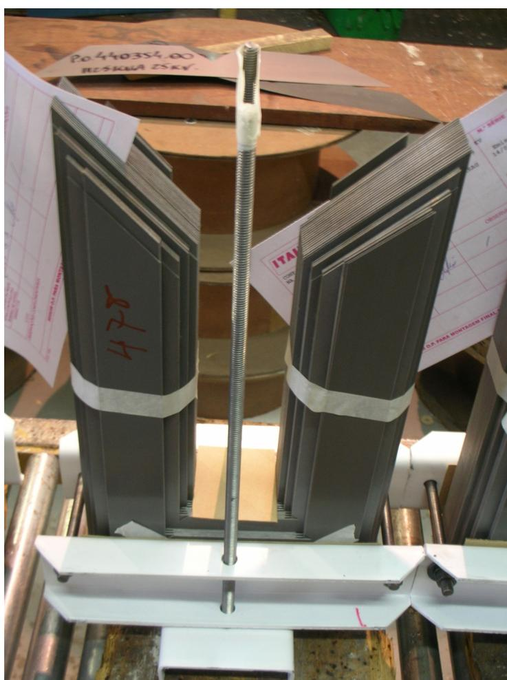
**Figura 5.4 – Núcleo composto com lâminas de aço-silício.**
