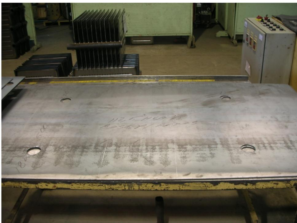
**Figura 3.16 – Chapa de aço usada para confeccionar o tanque do transformador.**
