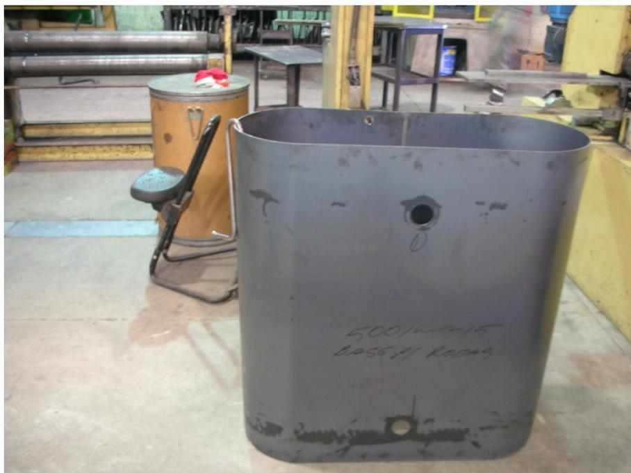
**Figura 3.17 – Tanque do transformador pronto para ser soldada a parte inferior.**
