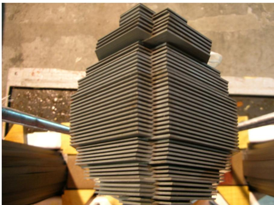
**Figura 3.11 – Núcleo de aço-silício formado por lâminas.**
