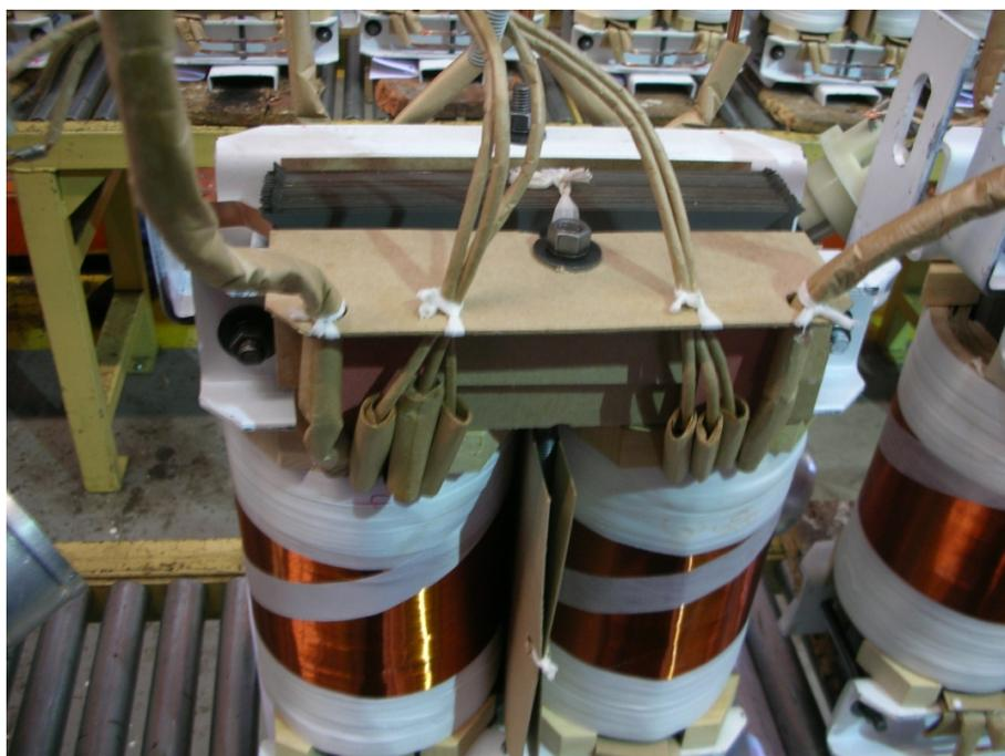
Figura 2.2 – Parte ativa de um transformador monofásico.
