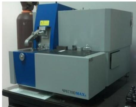
Figura 17– Espectrômetro de emissão ótica da IMBEL
