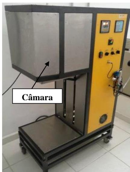
Figura 22 – Forno de sinterização
