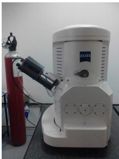
Figura 24 – Microscópio eletrônico de varredura
