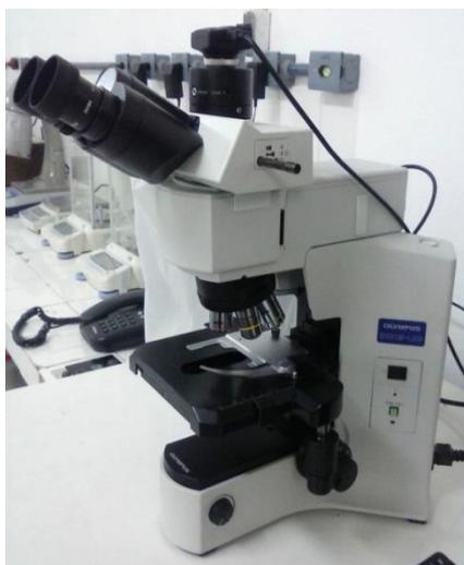
Figura 26 – Microscópio óptico metalúrgico
