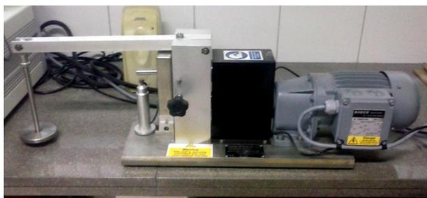
Figura 29 – Equipamento de resistência ao desgaste
