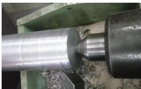
Figura 18 – Processo de usinagem do aço AISI 52100
