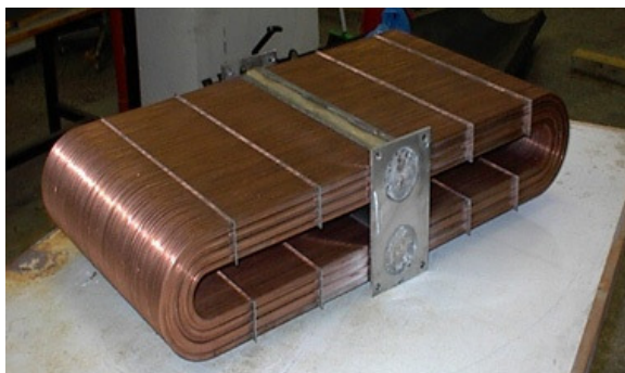
Figura 2.14 - Recuperador utilizado no projeto de turbina a gás (Yakinthos et al., 2006)
