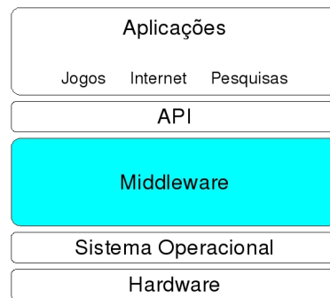
Figura 2.2: Arquitetura de um sistema de TVD com a camada do middleware
