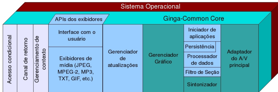
Figura 2.4: Componentes do Ginga Common Core
