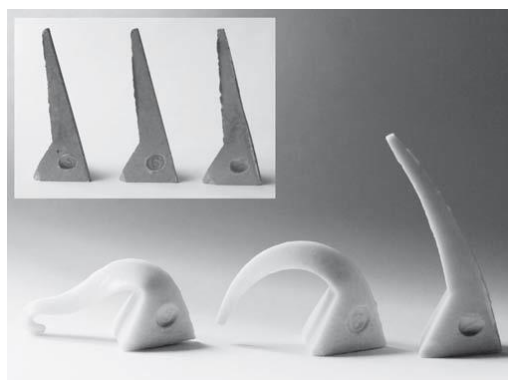
Figura 2.8 - Cones Orton. No destaque, antes da queima. Na imagem principal, um cone caído, um intermediário e um no início da queima. Fonte:(CARTER e NORTON, 2007)
