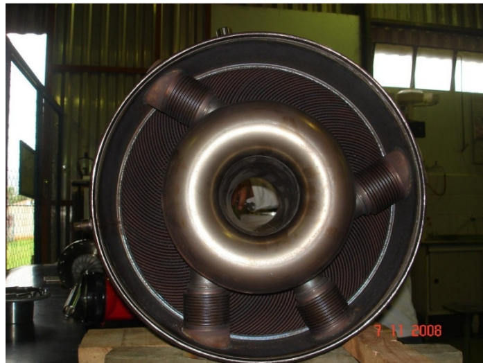
Figura 3.5 Vista Traseira de uma Câmara de Combustão Anular
