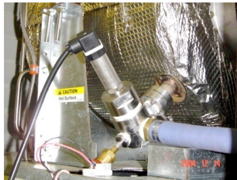
Figura 5.8 Medição de Pressão e Temperatura na Saída do Compressor
