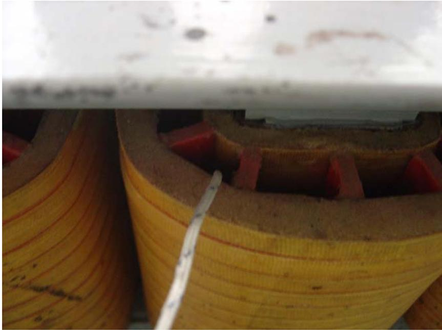
**Figura 3.19 – Inserção do termopar.**
