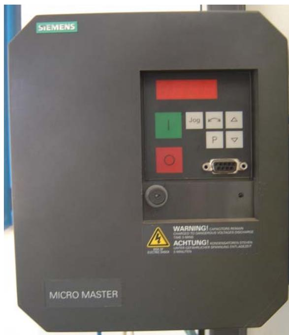
**Figura 3.15 – Inversor de frequência.**
