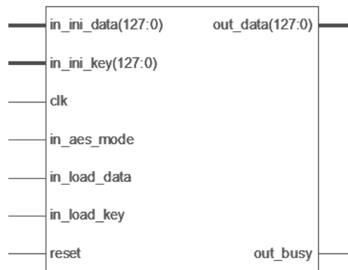
Figura 5.15: Blocos RTL do AES-128
