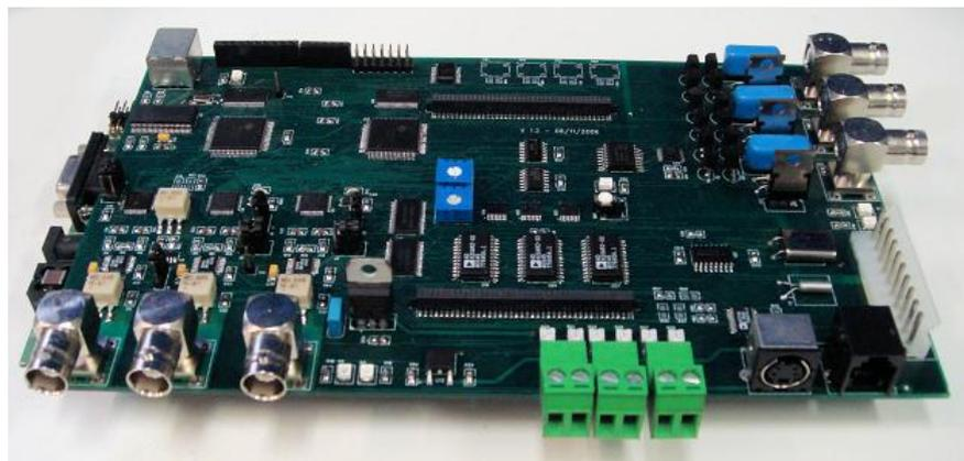
**Figura 4:** Foto da placa de aquisição e interfaces.
