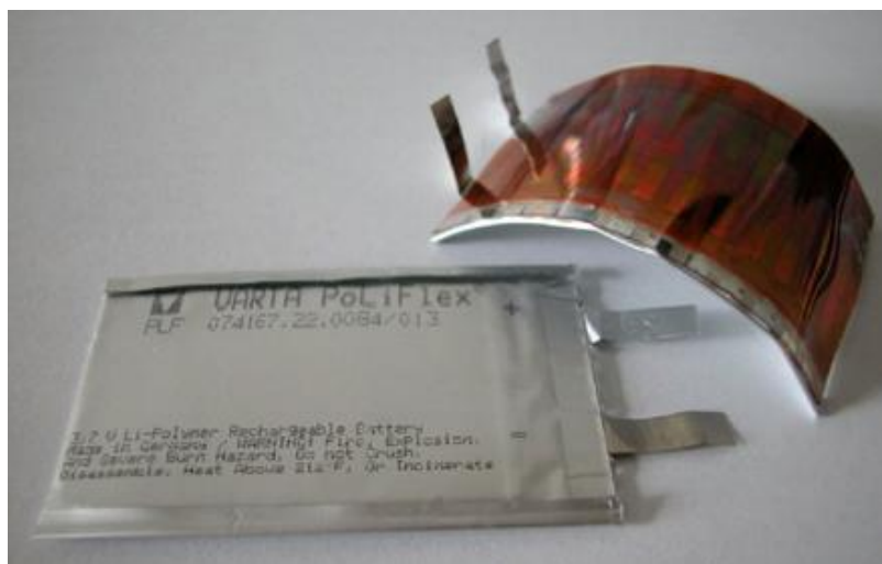
Figura 8 – Célula solar de polímero processada em um substrato de ITO 175 \mu\text{m} revestido de PET, combinado com uma bateria Poliflex [51].
