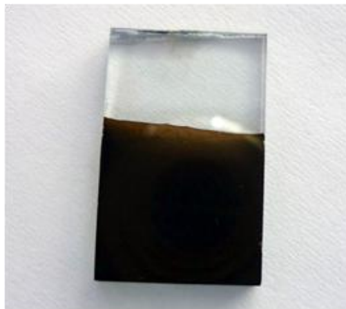
Figura 28 – Filme PPy/ [(\text{CH}_2\text{COO})_2\text{-DMIT}]^{2-} obtidos pela eletropolimerização oxidativa do pirrol na presença do 4,5-bis(carboximetilsulfanil)-1,3-ditiola-2-tiona (\text{CH}_2\text{COOH})_2\text{-DMIT} - sobre eletrodos de ITO.
