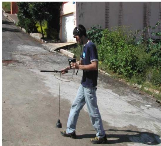
Figura 9 - Campanha de campo para a verificação da existência de vazamentos.
