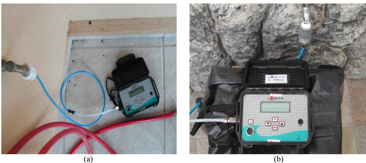
Figura 10 - (a) e (b) Medidores de pressão com armazenador de dados instalados em pontos diferentes de monitoramento.
