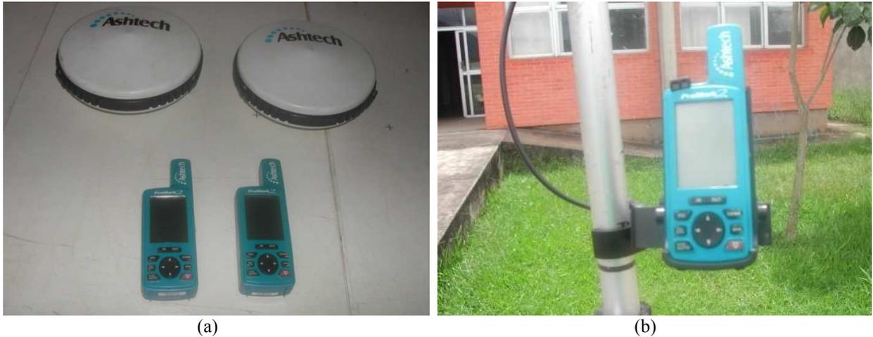
Figura 14 (a) e (b) – equipamento DGPS utilizado na verificação das cotas.
