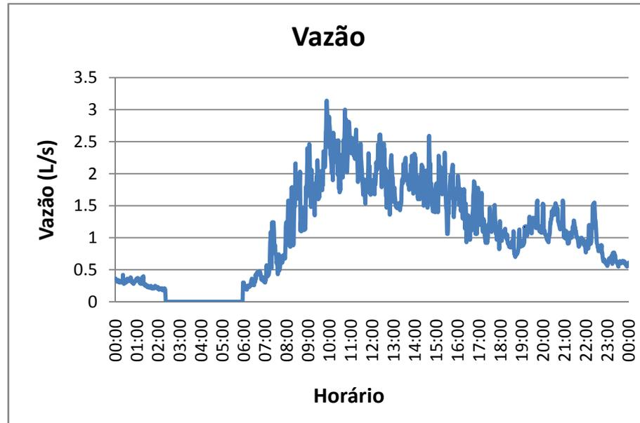
Figura 23 – Variação da vazão de saída do reservatório medida durante 24 horas.
