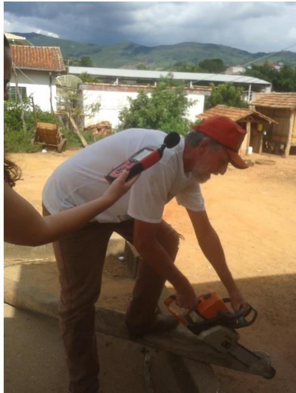
**Figura 5** – Medição do ruído de motosserra em Conceição das Pedras – MG
