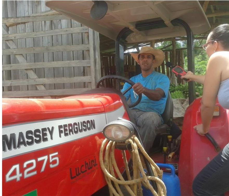
**Figura 4** – Medição do ruído de trator em Conceição das Pedras - MG
