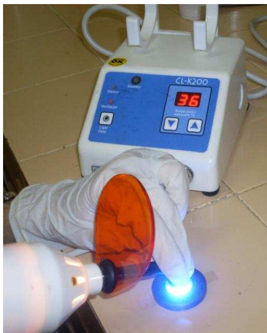
Figura 21: Fotopolimerização das amostras com aparelho fotopolimerizador da marca Kondortech.
