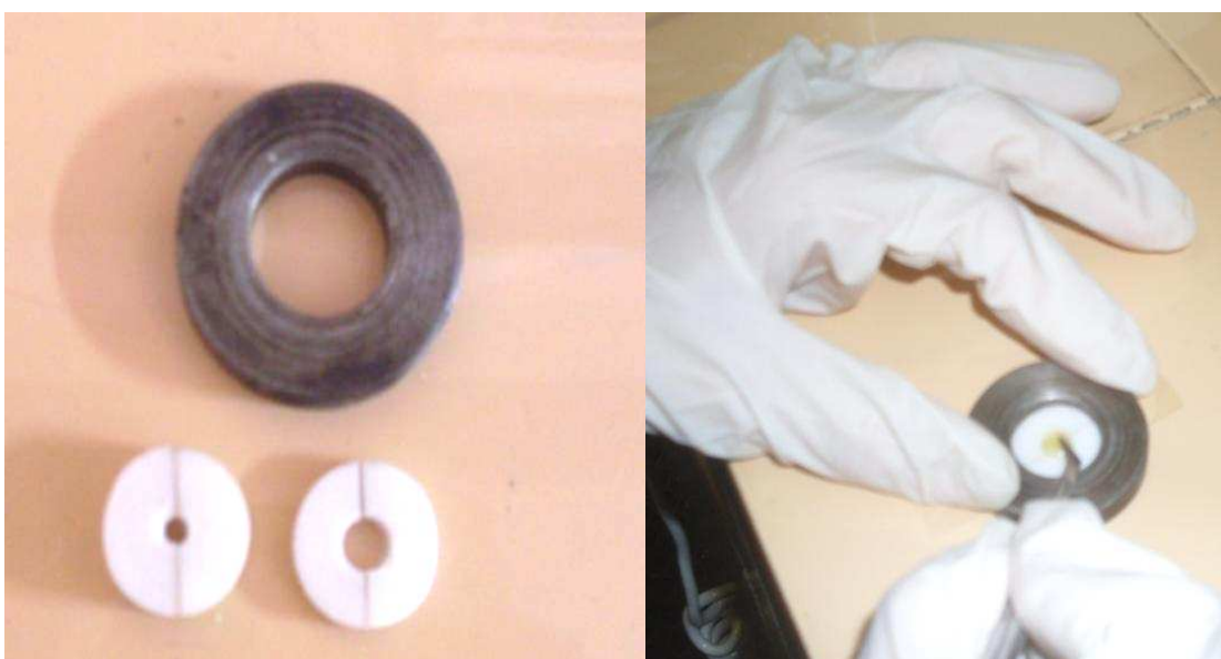
Figura 20: Moldes utilizados (esquerda) e etapa de confecção dos corpos-de-prova (direita).
