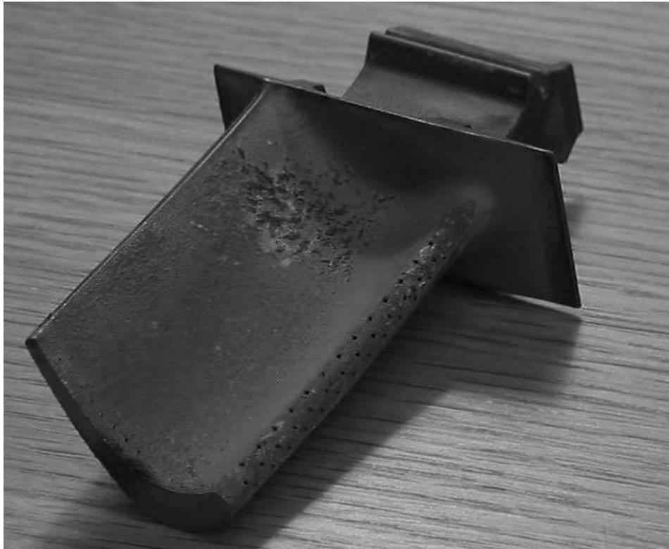
**Figura 1.1:** Desgaste natural de uma pá de turbina. Retirado de Keane e Nair (2005).
