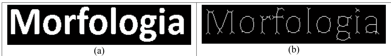
Fig. 4.20 – Esqueletonização: (a) imagem original; (b) imagem após esqueletonização.
