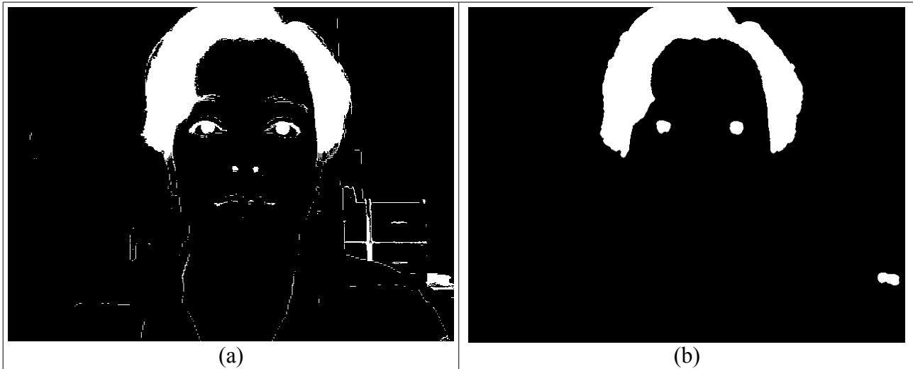
Fig. 5.3 – Segmentação por técnicas de morfologia matemática: (a) imagem após preenchimento de buracos; (b) imagem após operação de abertura.
