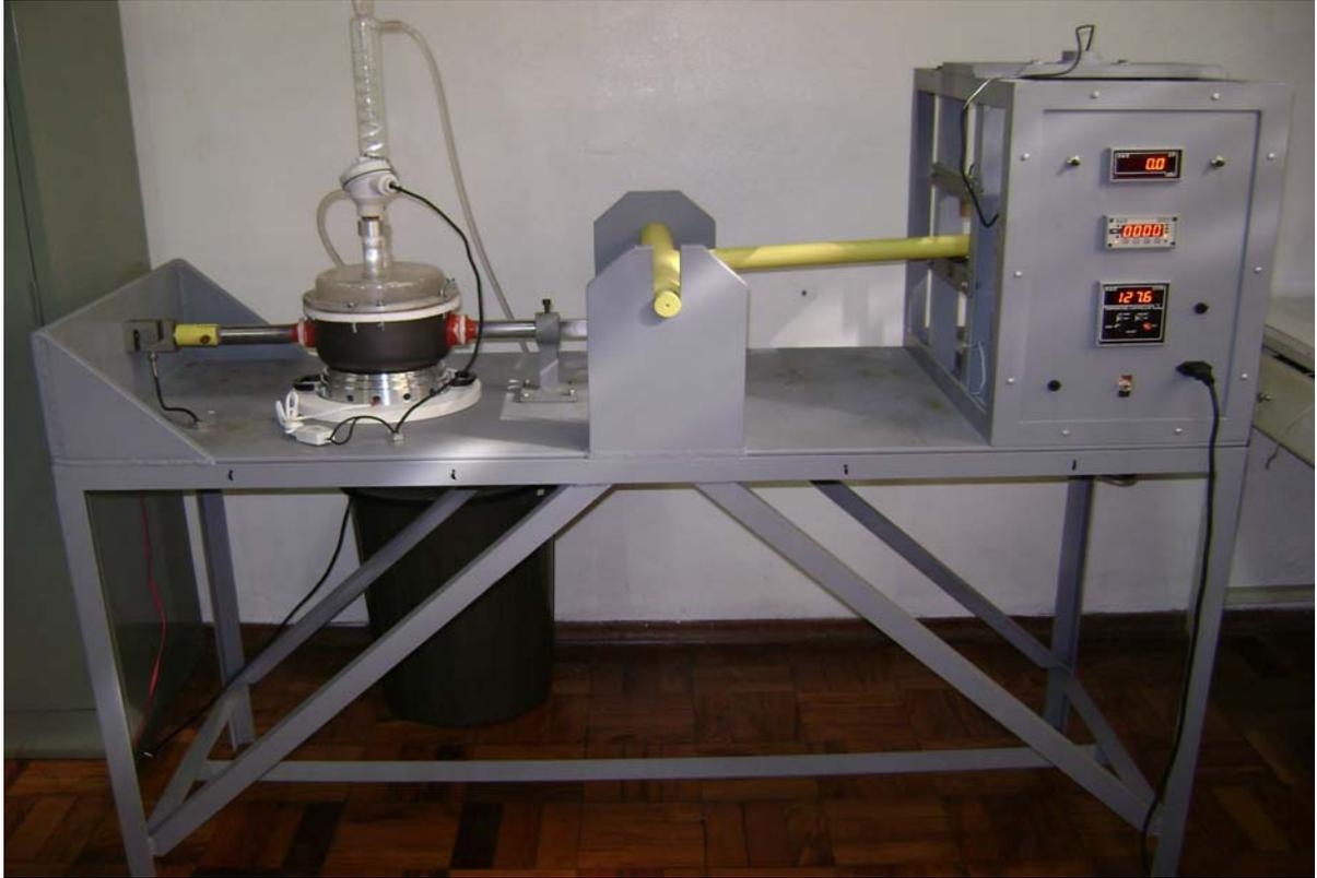
FIGURA 3.11: Banco de teste de corrosão sob tensão em funcionamento.
