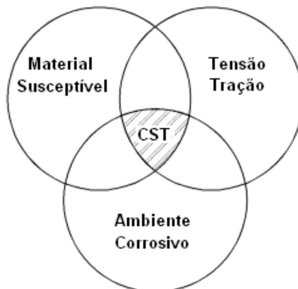
FIGURA 2.1: Pré-requisitos para a ocorrência da Corrosão Sob Tensão.
