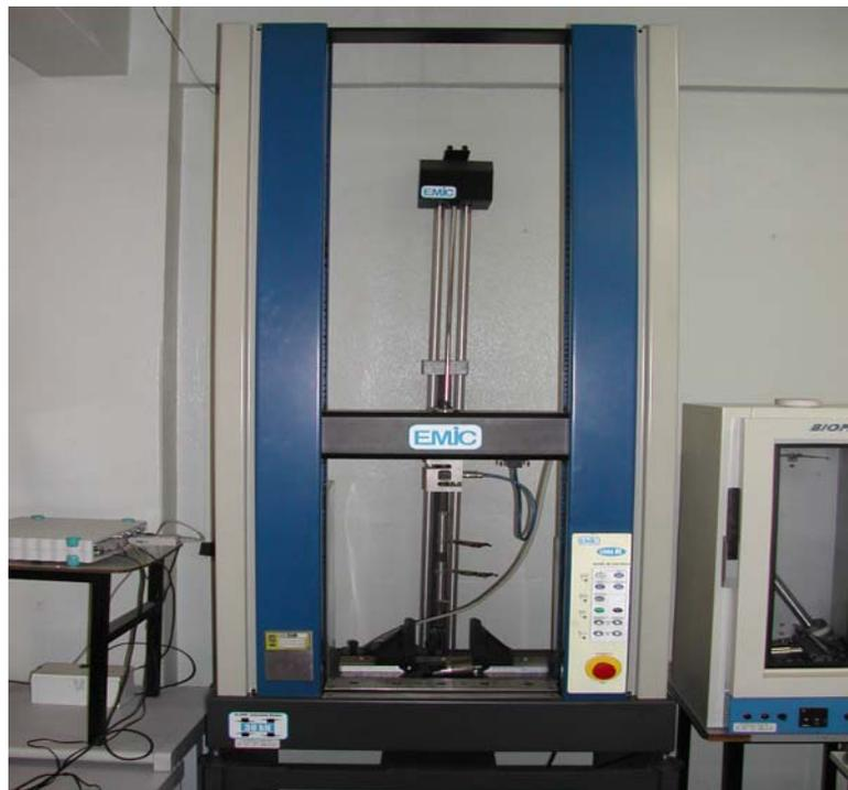
FIGURA 3.7: Máquina utilizada para ensaios de tração.
