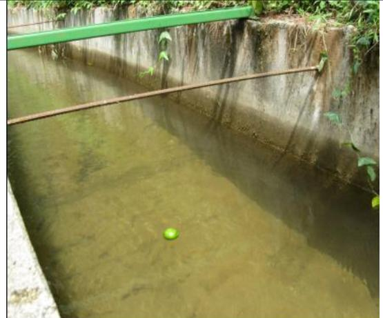
**FIGURA 4.4 - Medição de vazão pelo método do flutuador comparado com o micromolinete realizado no canal de adução**
