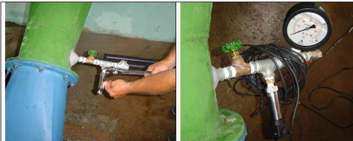
**FIGURA 3.18 – Instalação dos manômetros na entrada da turbina Michell-Banki (fonte: Viana, 2008)**
