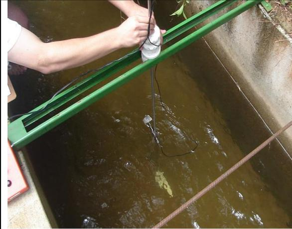
**FIGURA 4.3 - Medição de vazão no canal de adução com o micromolinete**
