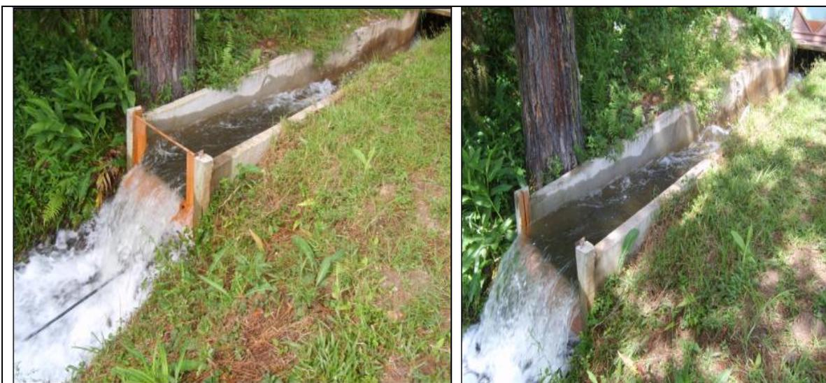
**FIGURA 4.2 - Medição de vazão no canal de fuga demonstrando os dois vertedores retangulares (com duas contrações e sem contração)**
