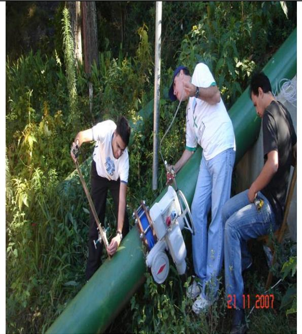
**FIGURA 4.3- Instalando os manômetros e transdutores entre a válvula borboleta**
