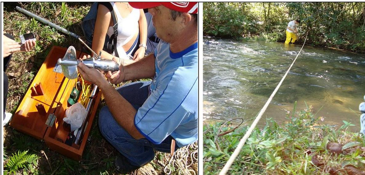
**FIGURA 4.3 -Medição de vazão com molinete hidrométrico no rio da ONÇA**
