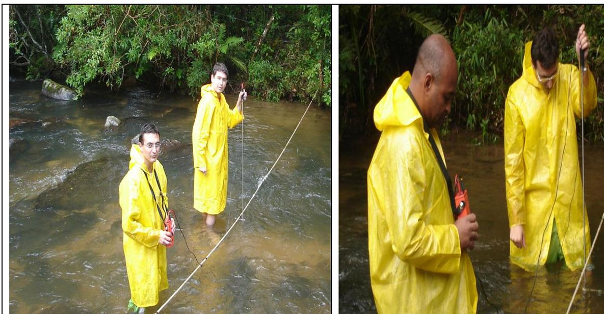
**FIGURA 4.2 - Medição de vazão com micromolinete no rio da ONÇA**
