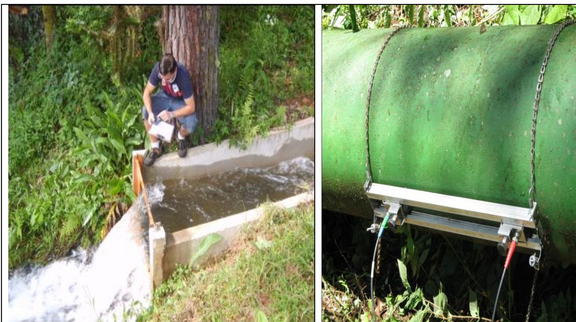
**FIGURA 4.3 – Ultra-som por tempo de trânsito instalado na tubulação da BFT e anotações do vertedor em uma planilha**
