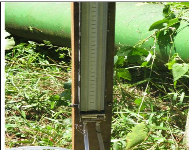
**FIGURA 4.3- Manômetro de coluna em U diferencial**
