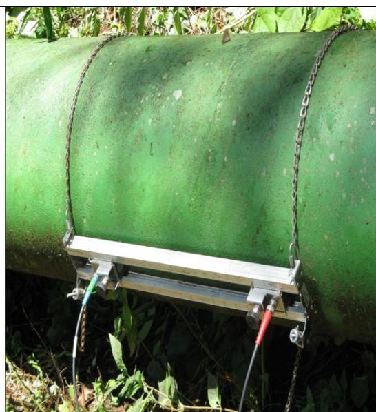
**FIGURA 4.6- Instalação no conduto forçado dois sensores para medidas da vazão com o medidor de ultra-som tempo de trânsito**
