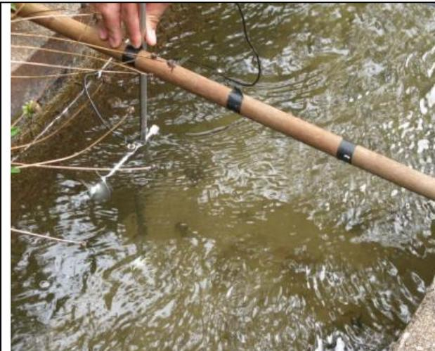
**FIGURA 4.5- Medição de vazão no canal dos peixes com o micromolinete**
