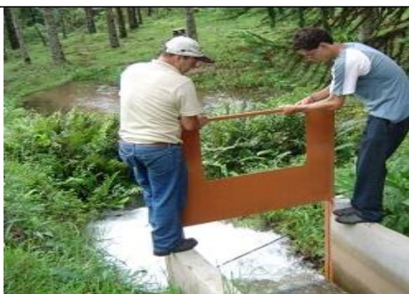
**FIGURA 3.17 – Suporte no canal de fuga para colocação de vertedores (fonte: Viana, 2008).**
