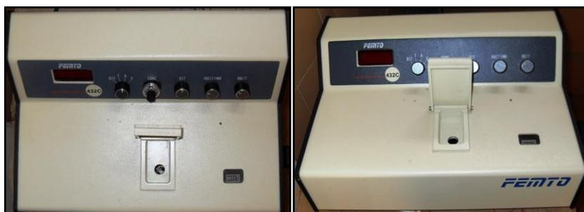
Figura 3.8: Espectrofotômetro FEMTO, modelo 432 C.
