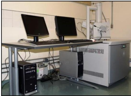
Figura 3.17: Microscópio eletrônico de varredura, modelo FEI – Quanta 200, que apresenta uma faixa de voltagem entre 200 V e 30 kV.
