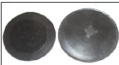
Figura 2.11: Compósito polimérico à base de resina epóxi com grafite.
