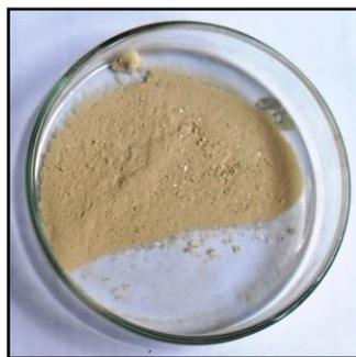
Figura 4.2: Partículas de prata, método redox por sulfato ferroso
