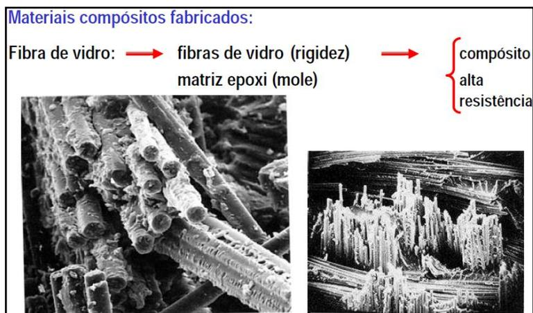
Figura 2.10: Compósito fabricado, www.ufrgs.com.
