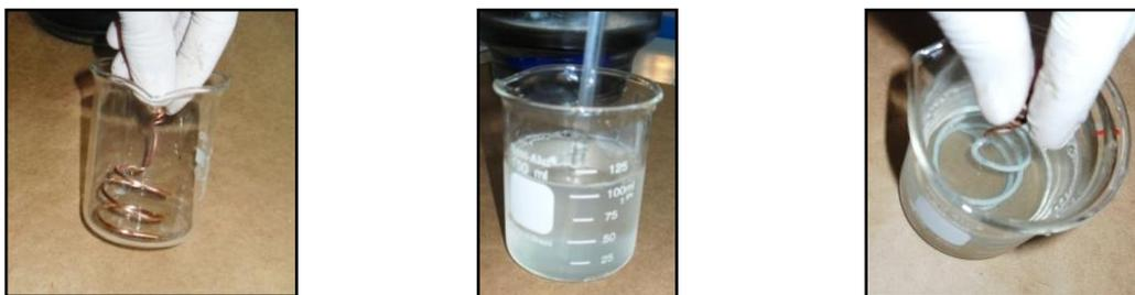
Figura 3.7: Síntese da prata metálica utilizando cobre; a) Becker, fio de cobre; b) Solução água destilada, ácido nítrico e nitrato de prata; c) Início da reação.
