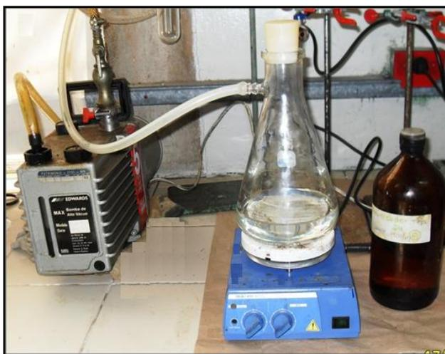
Figura 3.11: Desidratação da resina epoxídica.
