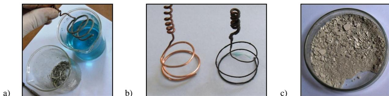
Figura 4.3: Obtenção de prata metálica (Cobre); a) Reação de óxido-redução; b) Redução do diâmetro do fio de cobre; c) Prata metálica resultante da reação.
