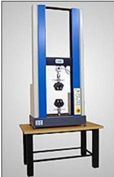
Figura 3.23: Máquina Universal para Ensaio mecânicos, EMIC, modelo DL 2000.
