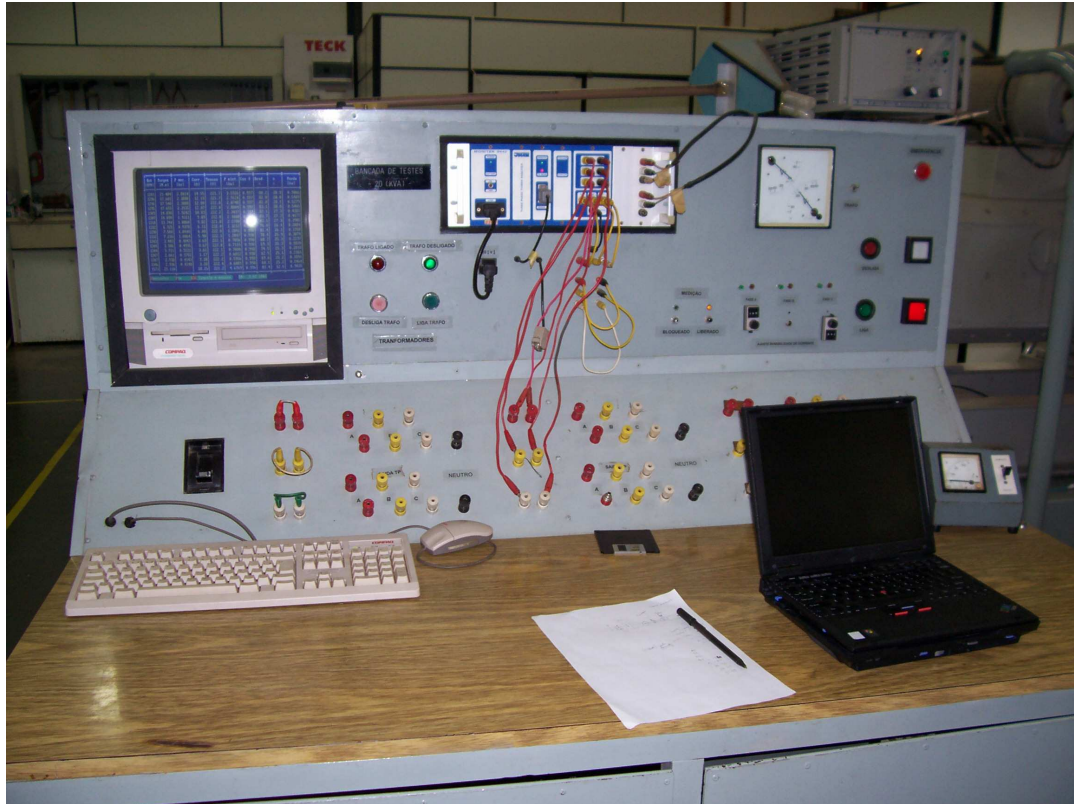
Figura 5.2 – Visão geral do Analisador trifásico MONITEK
