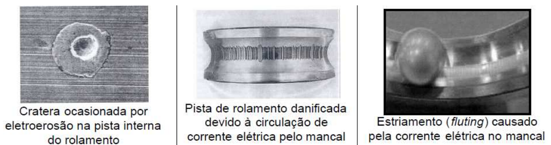
Figura 4.7– Danos causados em mancais
