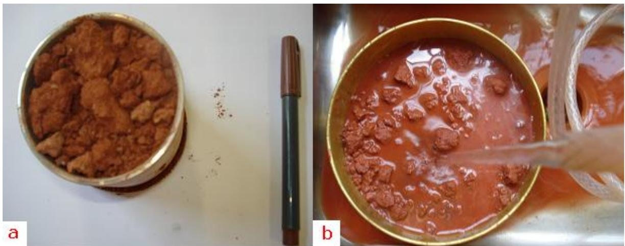
Figura 4.11: Etapas da metodologia utilizada para a análise de densidade de raízes. a) Massa de solo em um volume conhecido; b) Lavagem do solo para separação das raízes.
