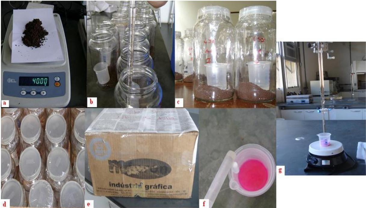
Figura 4.9: Etapas da metodologia utilizada para a análise de atividade e biomassa microbianas. a) Pesagem da amostra de solo; b) Introdução da amostra e do NaOH nos vidros; c) Amostras lacradas para posterior incubação (fumigadas e não fumigadas); d) Introdução das amostras em caixas para posterior incubação; e) Incubação por um período de 10 dias; f) Preparação para a titulação; g) Titulação com HCl.
