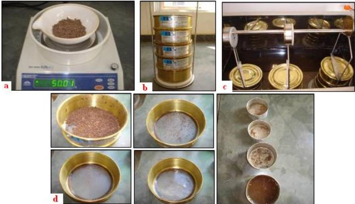
Figura 4.5: Etapas da metodologia utilizada para a análise de estabilidade de agregados via - úmida. a) Pesagem da amostra de solo; b) Conjunto de peneiras; c) Agitamento das amostras; d) Agregados em cada peneira.
