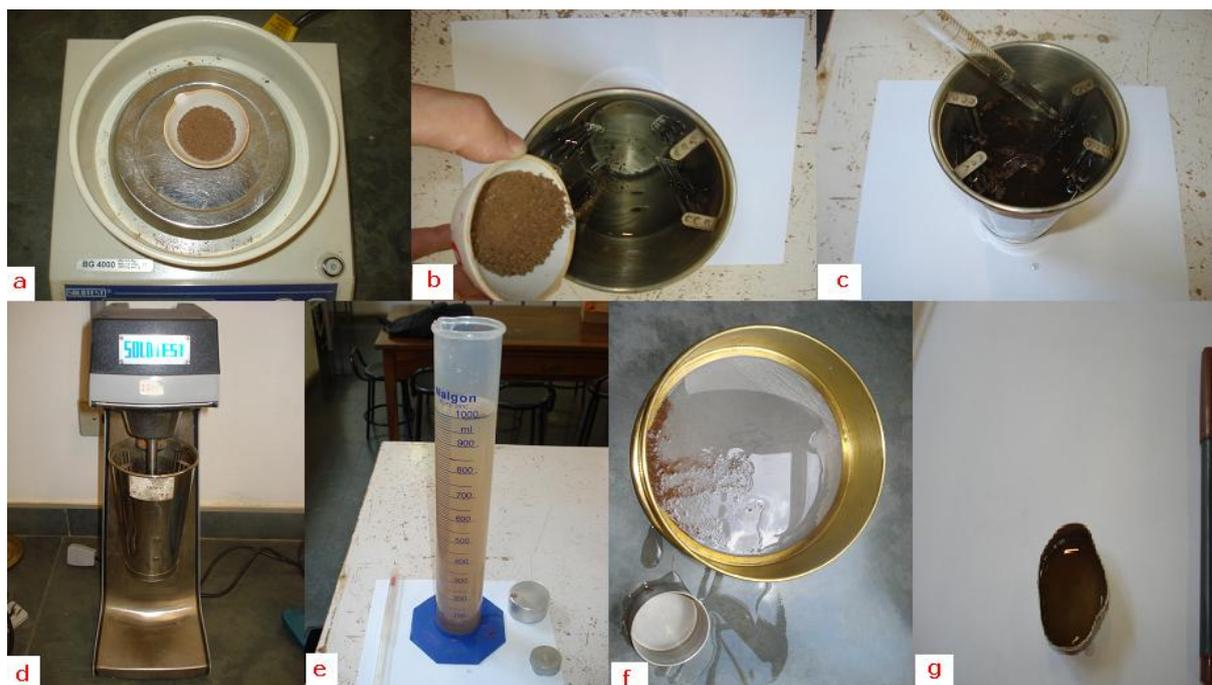
Figura 4.8: Etapas da metodologia utilizada para a análise de textura. a) Peso da amostra de solo; b) Preparação para a agitação mecânica; c) Preparação para agitação mecânica; d) Agitação mecânica; e) Decantação; f) Separação da areia; g) Separação da argila.
