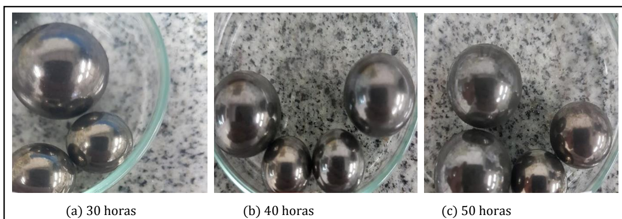
Figura 48 - Esferas presentes no processo de moagem do material – 1% Ácido Esteárico
