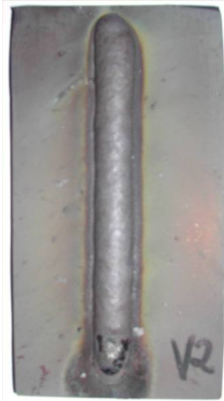
Figura 4.33 – Formação de escória ótima
