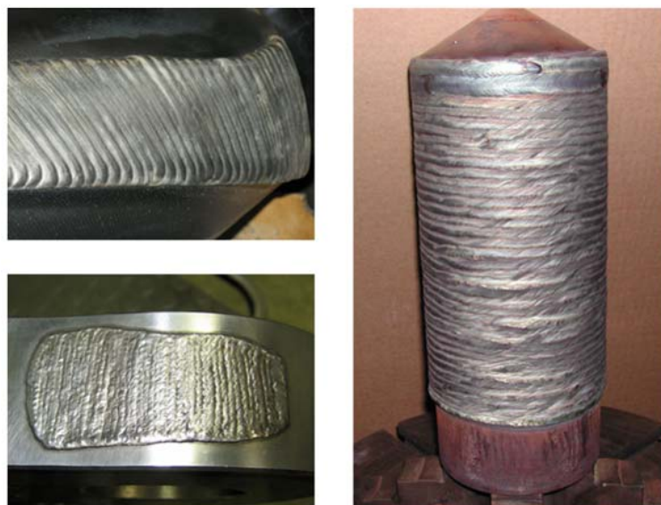
Figura 2.2 – Exemplos de camadas de revestimento depositadas a partir de processos de soldagem
