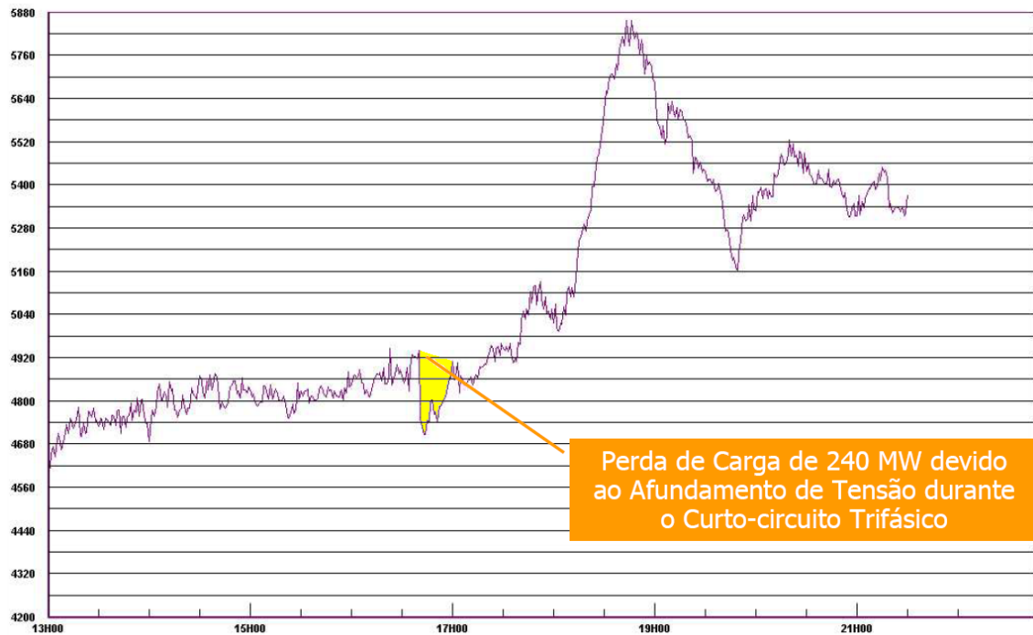
Figura 3.1 - Determinação da perda de carga e da ENS a partir da curva de carga
