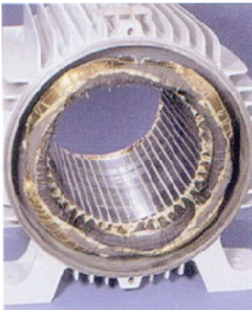
Figura 38 Fase Danificada por Desbalanceamento de Tensão da Rede [4]
