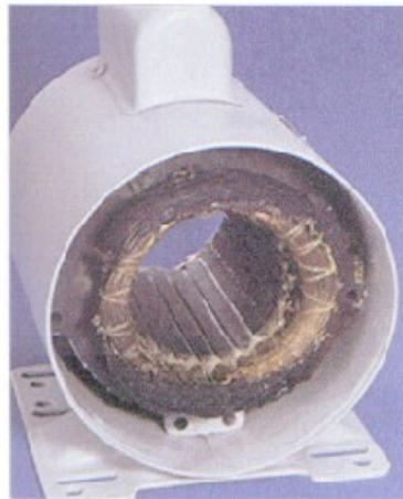
Figura 40 Queima na Bobina Principal [4]
