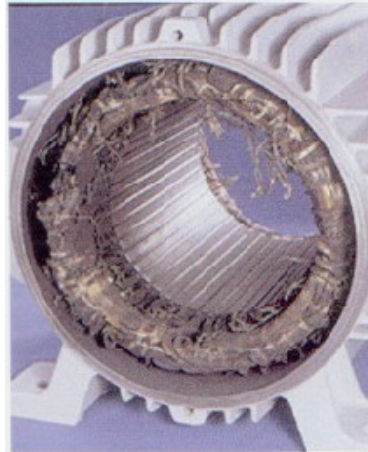
Figura 36 Queima por Sobrecarga [4]
