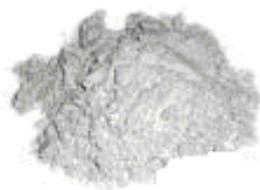
Figura 9: Amostra de gesso empregado ao final do processo de fabricação de cimento Portland.
