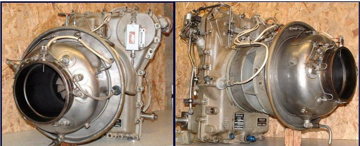
Figura 5. 1 Microturbina, modelo T-62T-32 fabricada pela Solar Turbines.
