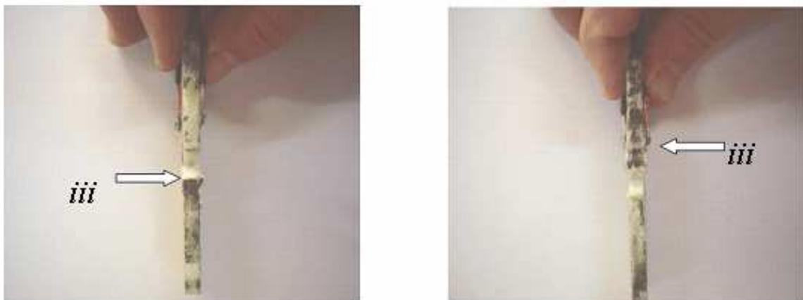
Figura 42 – Faces de apoio da amostra de referência radial. (Souza, 2006)
