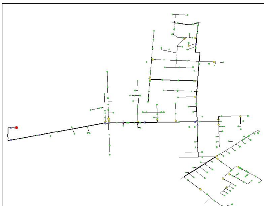
Figura 4.1 – Exemplo de topologia de um circuito real de distribuição em média-tensão urbano
