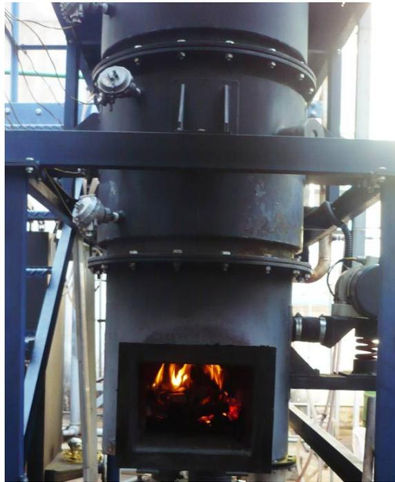
Figura 3.14. Preaquecimento do reator.
