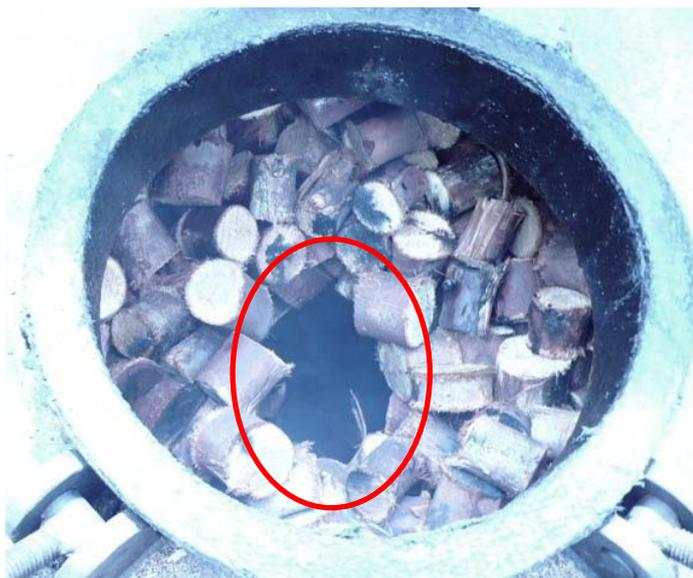
Figura 4.23. Evidencia de formação de espaço morto (vazio) no reator.
