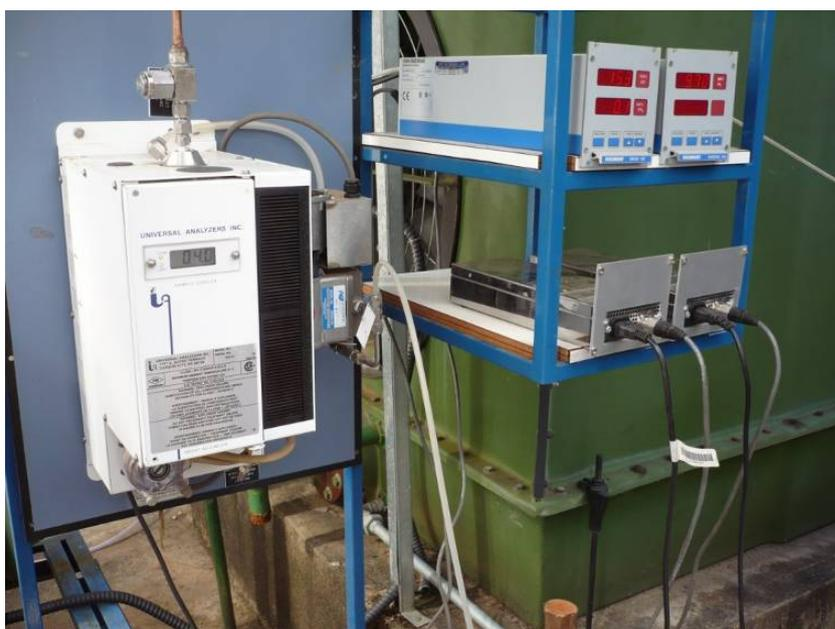
Figura 3.7. Sistema de análise gases.
