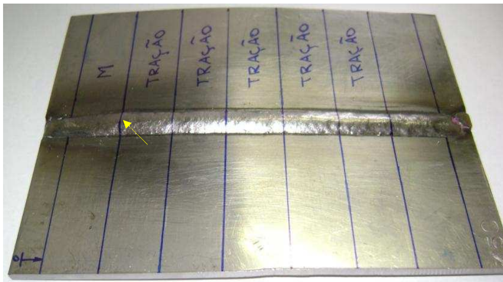
Figura 3.9 – Regiões definidas para os ensaios metalográfico e de tração.
