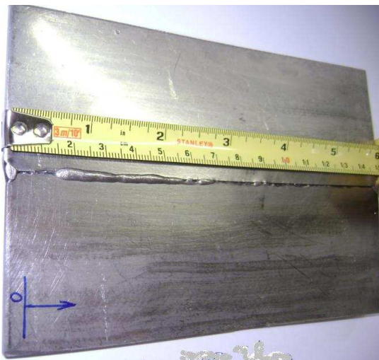
Figura A.4 – Falta de penetração e fusão da junta soldada com H = 549,7 J/mm.
