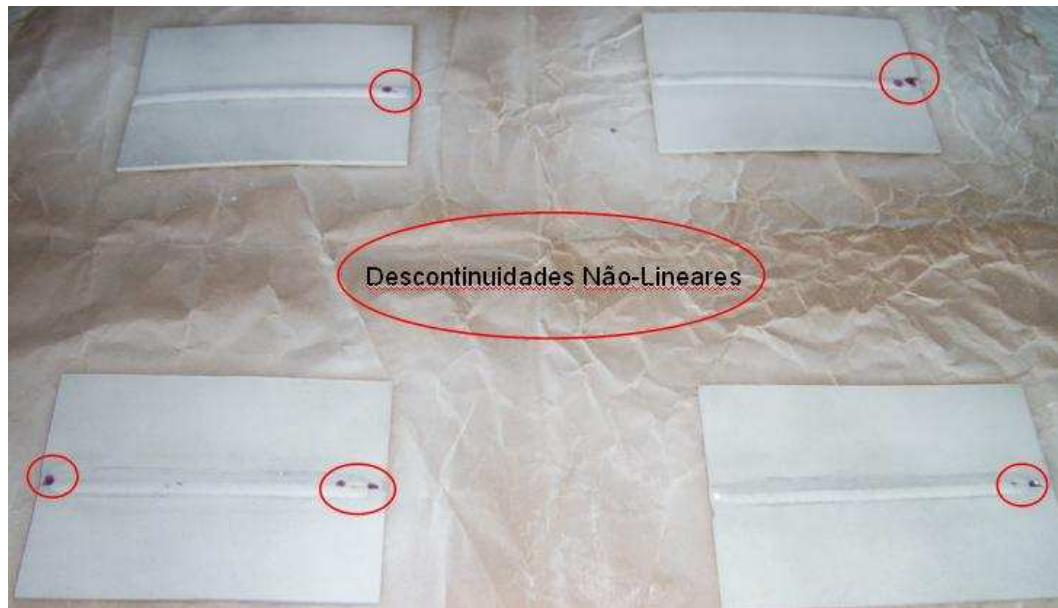
Figura 4.33 – Indicações das descontinuidades superficiais através do ensaio de LP.
