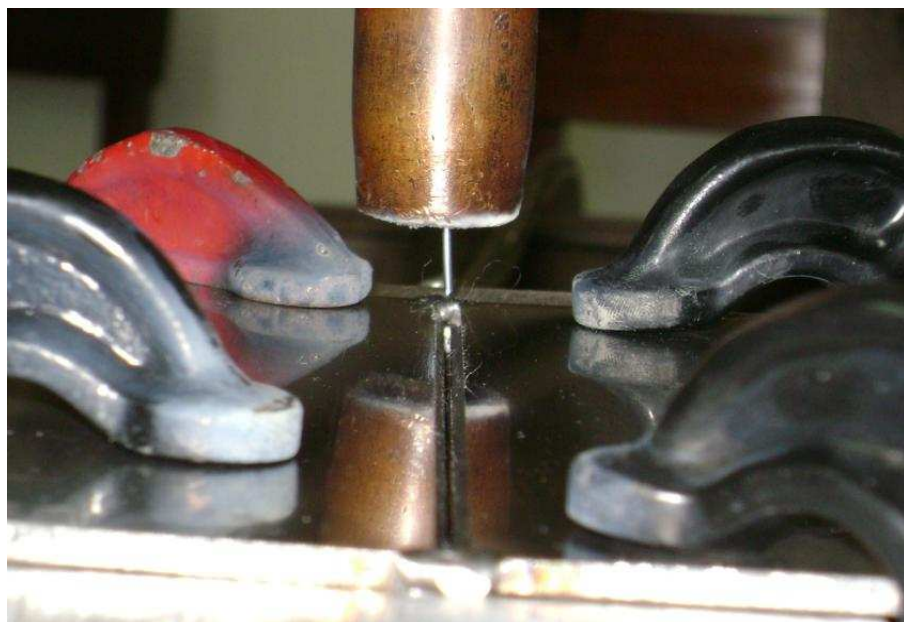
Figura 4.30 – Corpo-de-prova com um chanfro em V de 60^\circ , abertura de raiz de 1,2\text{mm} e nariz de 1,5\text{mm} .
