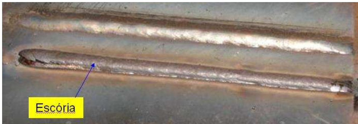
Figura 2.20 – Escória do arame tubular AWS E316LT1-4.
