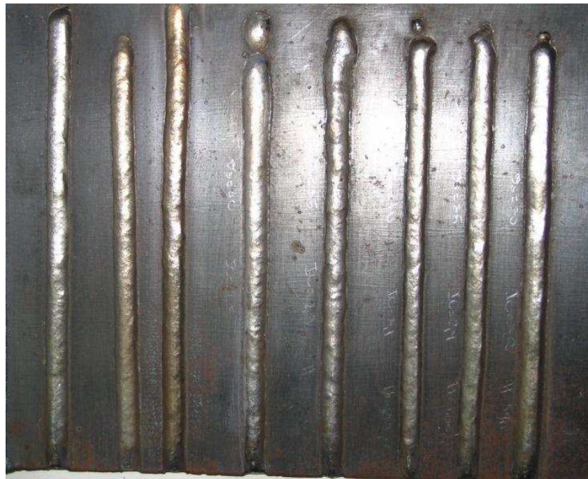
Figura A.2 – Testes exploratórios em aço 1020 de ½ polegada.
