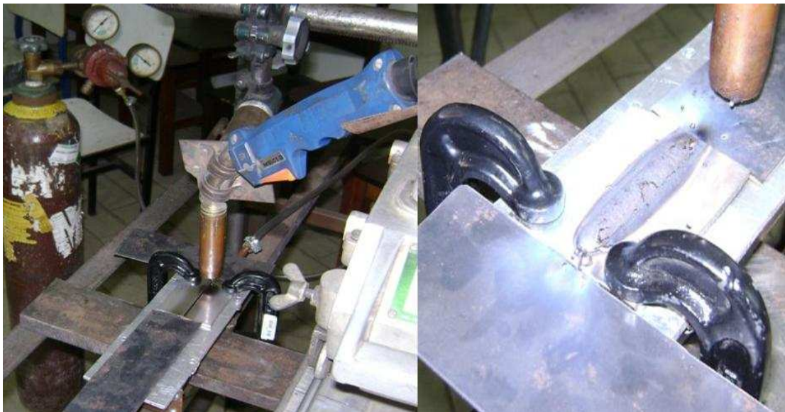
Figura 3.4 – Testes para análise da penetração com H = 450,4 J/mm e H = 650,7 J/mm.
