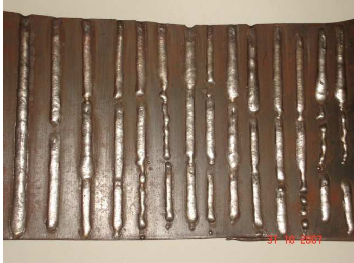
Figura A.1 – Testes exploratórios em aço 1020 de ½ polegada.
