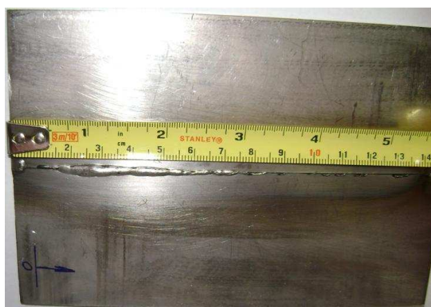
Figura A.5 – Falta de penetração e fusão da junta soldada com H = 590 J/mm.
