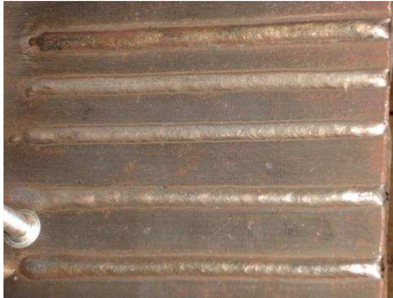
Figura A.3 – Testes exploratórios em aço 1020 de ½ polegada.
