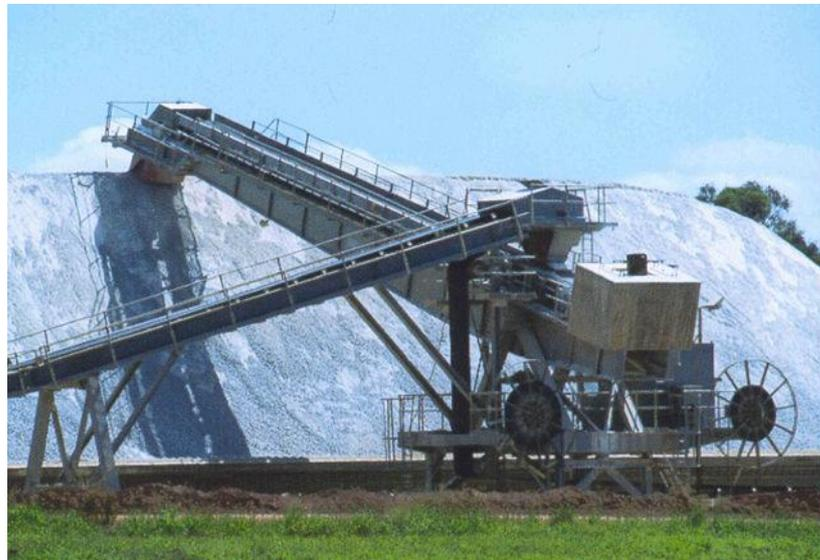
Figura 2.4 - Pré-homogeneização e estocagem do calcário.
