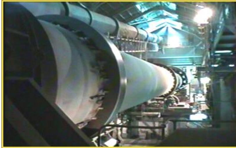
Figura 2.13 - Forno rotativo com pré-aquecedor e pré-calcinador.
