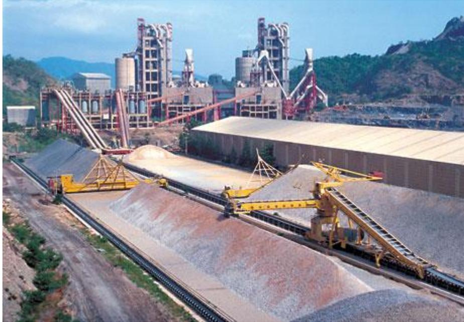
Figura 2.5 - Pré-homogeneização do calcário e argila.
