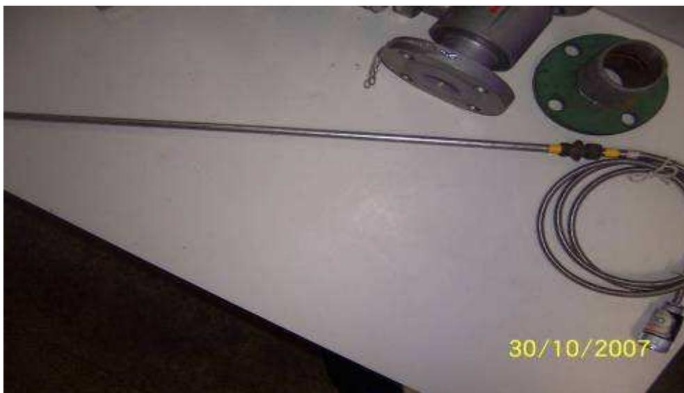
Figura 3.12 - Sonda de temperatura a ser instalada na máquina.
