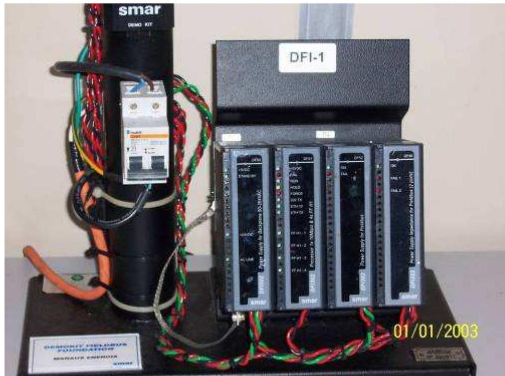
Figura 3.10 – DFI 302 (fabricante Smar Equipamentos Industriais)
