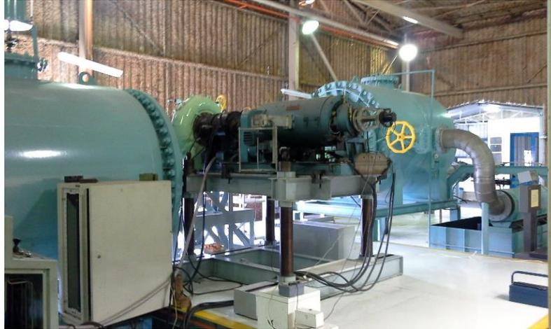
**Figura 5.5** – Freio Eletrodinamométrico LHEP
