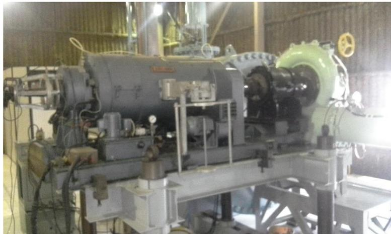
**Figura 5.11** – Freio Eletrodinamométrico LHEP
