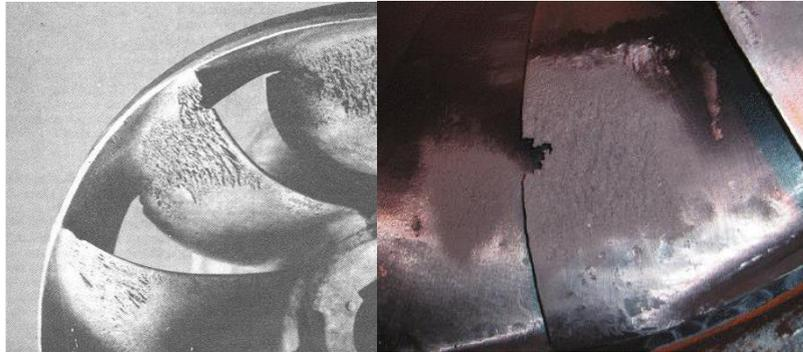
**Figura 3.2** Pás com erosão por efeito de cavitação
