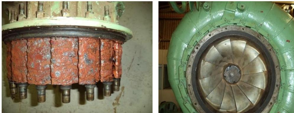
**Figura 5.14** Reparo no Anel de Fink, palhetas distribuidor e rotor turbina.
