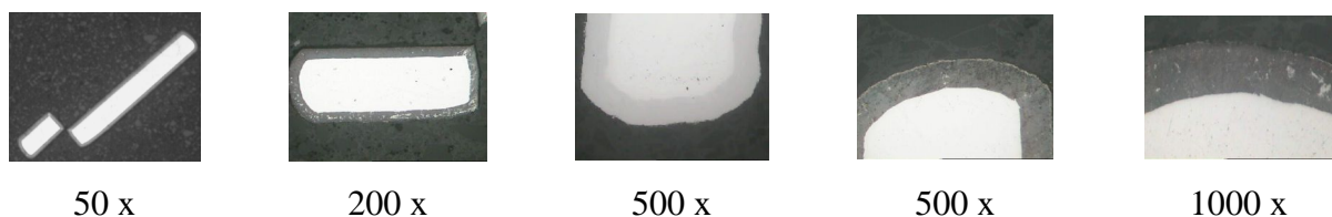
Figura 21 – Porosidade da camada nitretada a diferentes ampliações.
